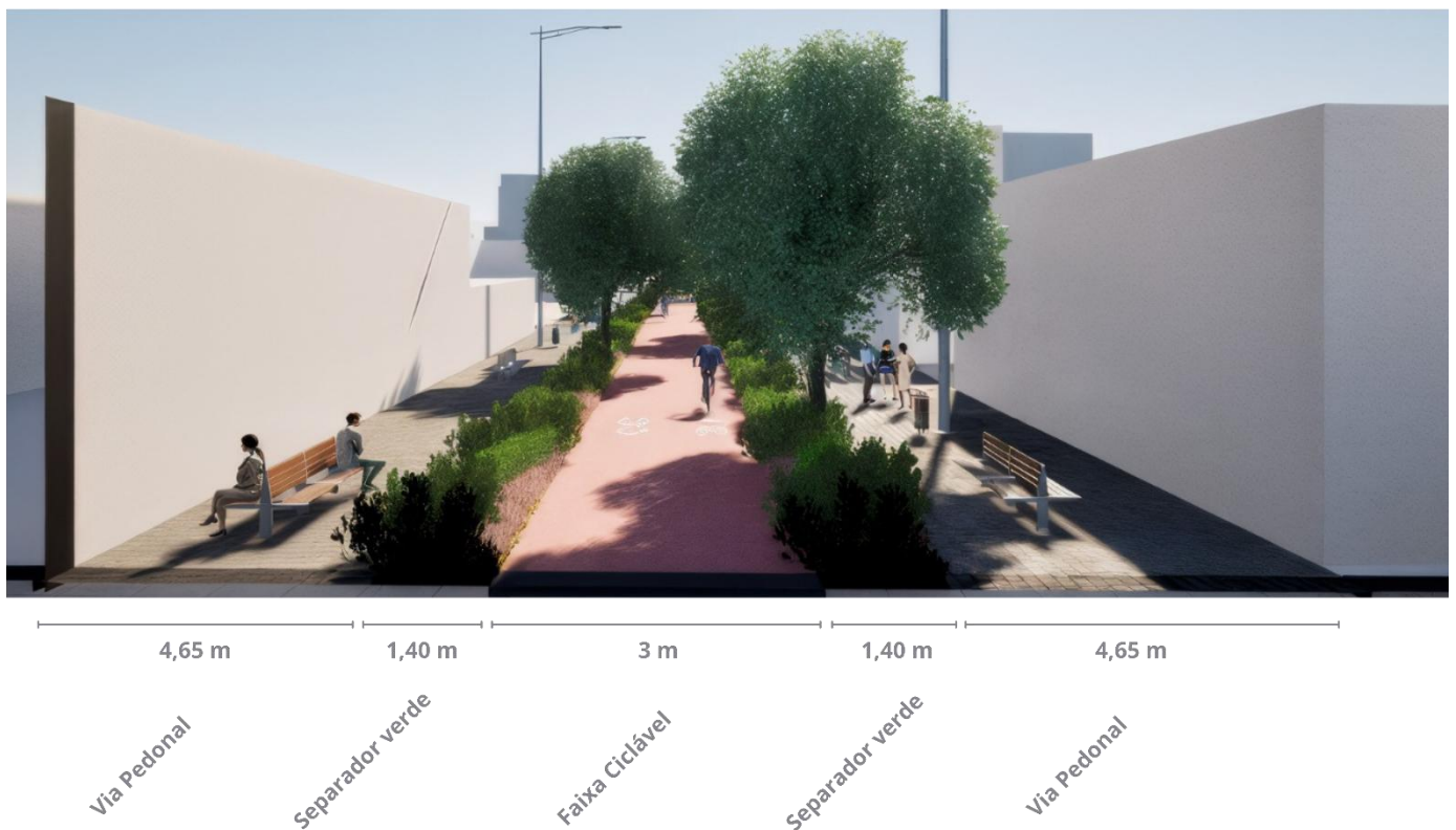
Figura 32 - Vista em corte da proposta para a rua Brito e Cunha, Fonte: Autor
