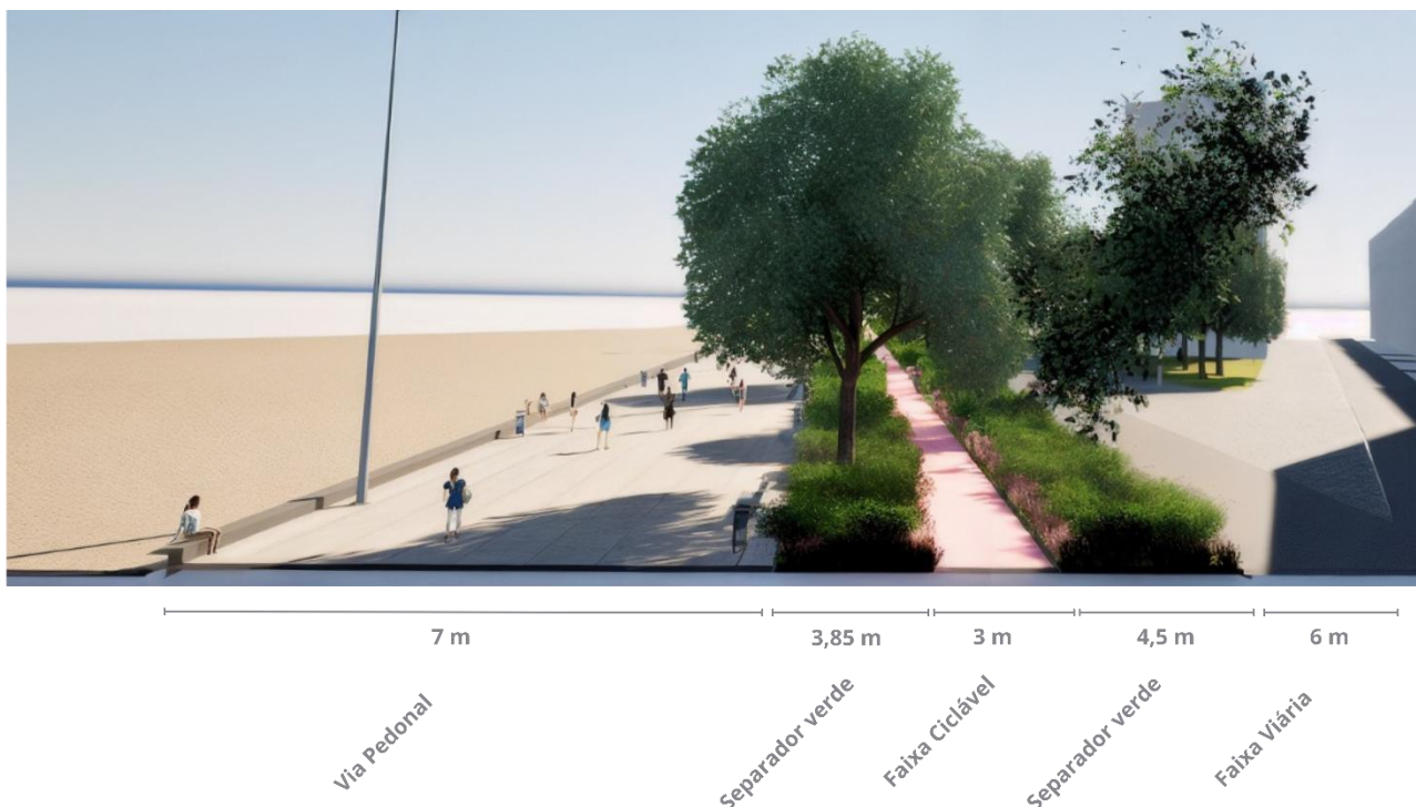
Figura 37 - Vista em corte da proposta para a Av. General Norton de Matos, Fonte: Autor
