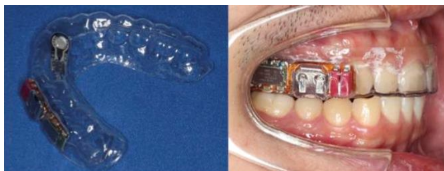
Fig. 6: Dispositivo de medição da pressão da língua com sensores piezoresistivos. Fonte: Real-Time Continuous Monitoring of Oral Soft Tissue Pressure with a Wireless Mouthguard Device for Assessing Tongue Thrusting Habits (Matsumoto et al., 2023)
