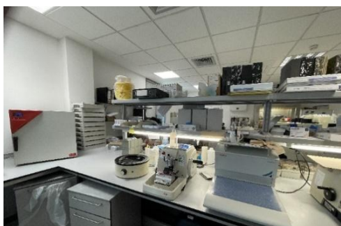
Figura 11-Fluxo do corte (da esquerda para a direita): estufa, banho-maria, micrótomo, placa de frio
