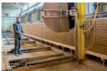
Figura 2 (a-d) Stabilimento di prefabbricazione pannelli in terra battuta di Martin Rauch: a) produzione dei pannelli; b) riduzione dimensionale; c) lavorazioni accessorie per l'accoppiamento; d) essiccazione e movimentazione dei pannelli finiti. (foto di Emmanuel Dorsaz).
