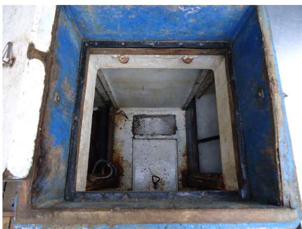
Figura 6 – Porão de armazenamento de pescado em avançado estado de degradação.
