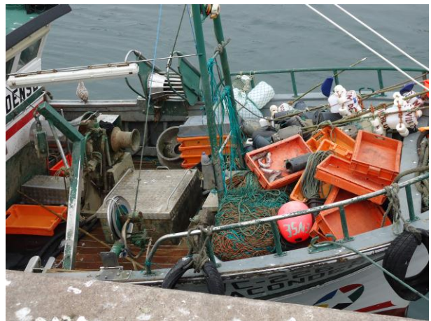
Figura 11 – Mau acondicionamentos das caixas.
