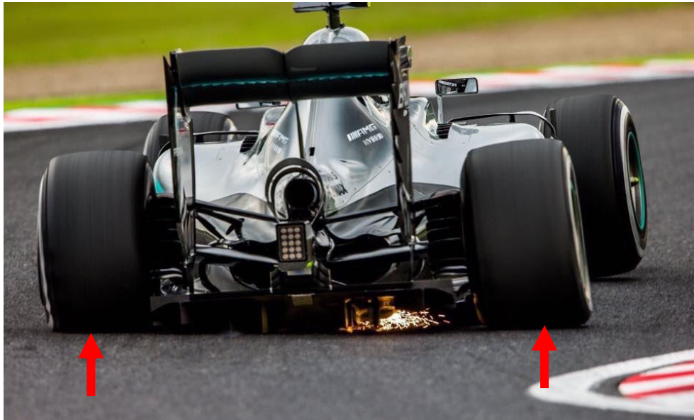
Figura 30. Deformação nos pneus, por slip angle, em corrida. (04/2020)
