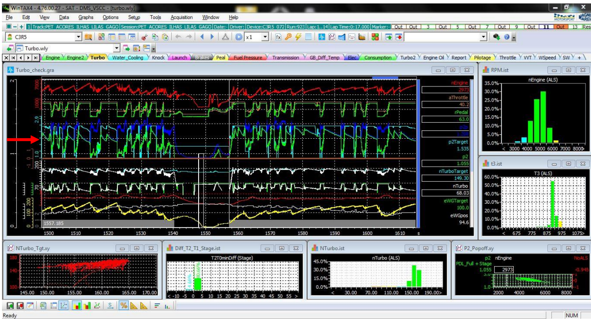
Figura 43. Comportamento do turbo durante volta de teste.
