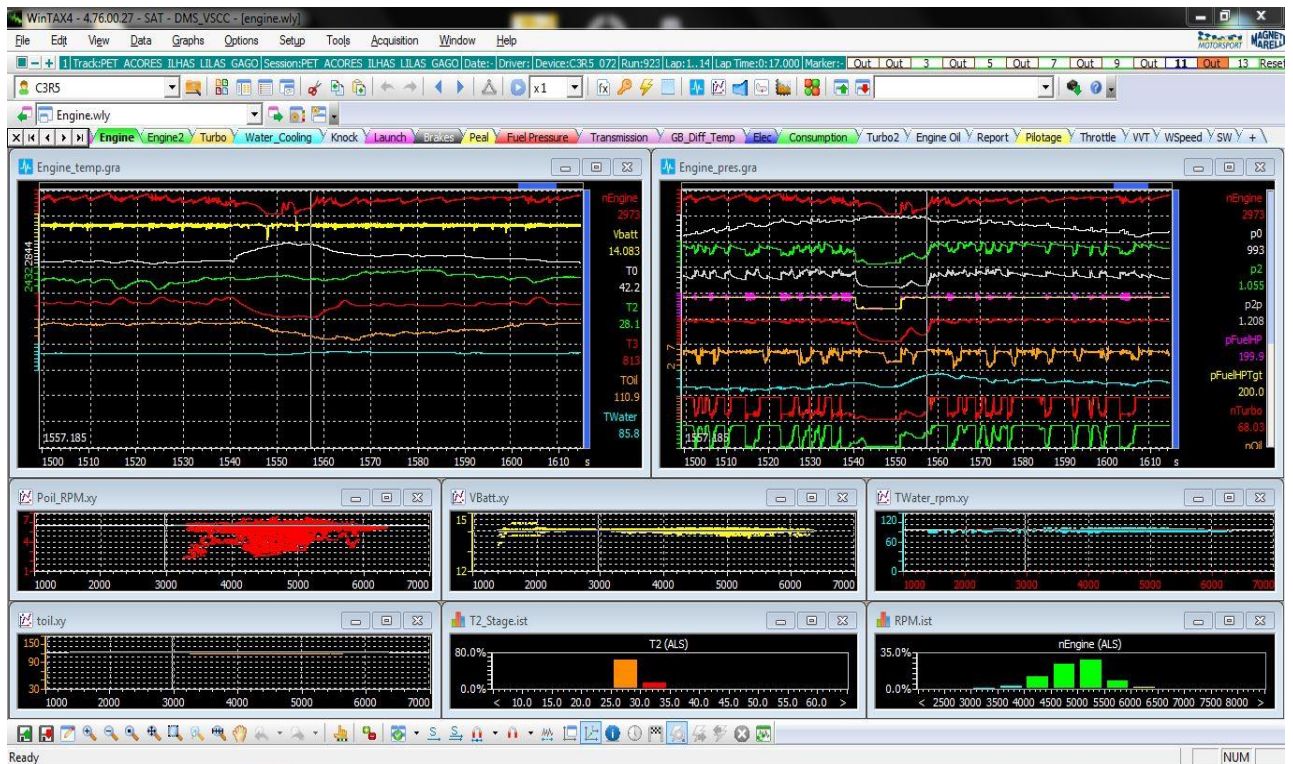
Figura 42. Interface com os dados para análise do comportamento do motor durante uma volta de teste.
