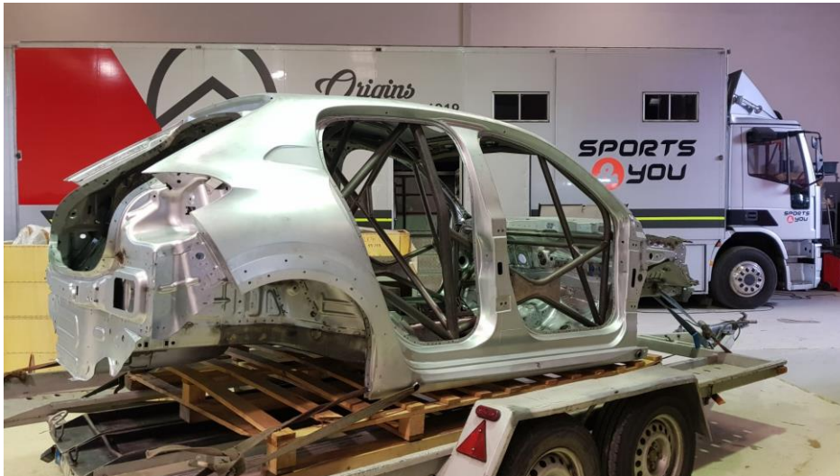
Figura 54. Carroceria depois de ser reforçada.
