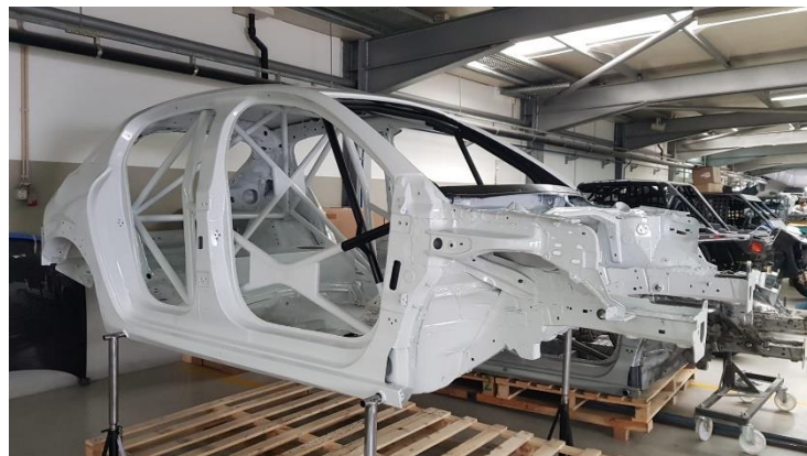
Figura 56. Resultado da estrutura após pintura.
