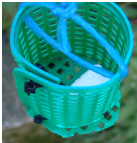
Fotografia 30: Cesto artesanal com pastilha de cloro no interior. Colocado no interior dos reservatórios de água.
