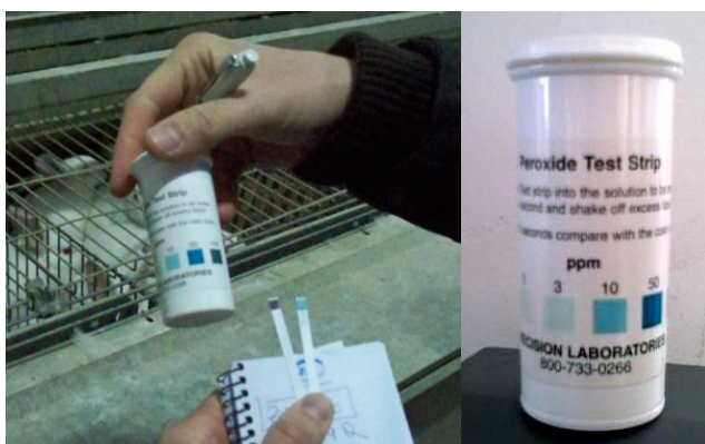
Fotografia 32: Tiras reativas para mensuração de Peroxido de Hidrogénio. Quantificação da sua concentração nas linhas de consumo dos coelhos.
