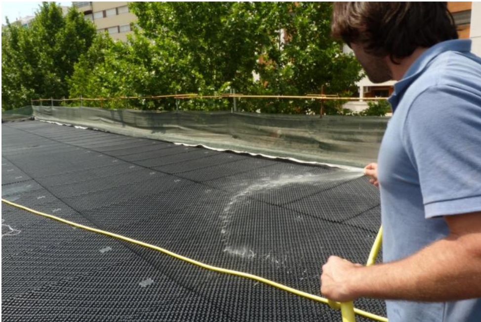
Figura 34 - Rega do elemento drenante para teste
