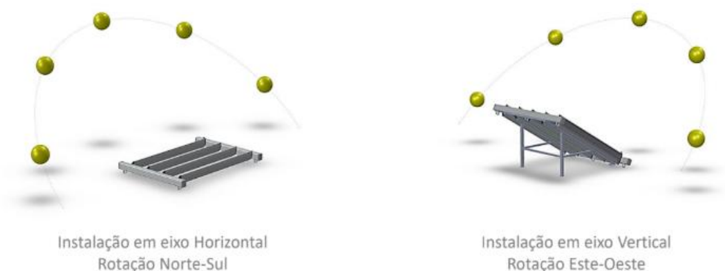
Figura 25 - Rotação das placas consoante o eixo de instalação do equipamento
