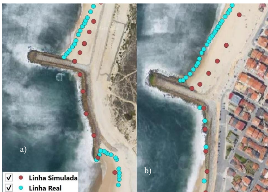
Figura 30 - Comparação nas zonas adjacentes aos esporões. a) esporão sul, b) esporão norte.
