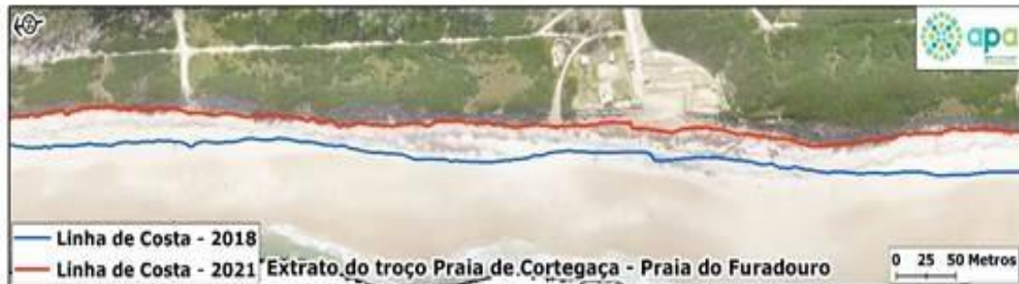
Figura 19 - Recuo da linha de costa na secção Norte da Praia do Furadouro (APA, 2022).
