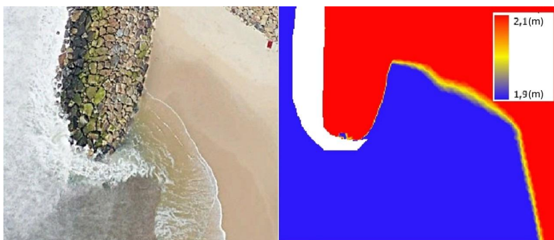
Figura 26 - Imagem real e representação da linha de costa à Cota 2 m (ZH).
