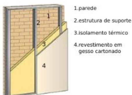
Figura 17 - Esquema de tipo de aplicação de isolamento térmico pelo interior [68]
