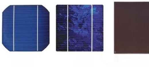
Figura 2.2: Células monocristalina, policristalina e de filme fino, respetivamente [12]
