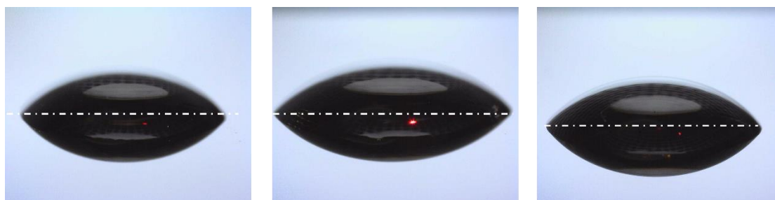
Figura 42 Fotografias representativas do perfil de gotas de 1,2-propeline sobre a superfície de eléctrodos de carbono vítreo (GC) não modificados. As imagens correspondem a três medições independentes utilizadas para a determinação do ângulo de contacto, com o objetivo de avaliar a molhabilidade da superfície do substrato em contacto com o líquido.
