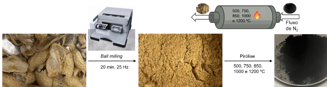
Figura 20 Processo de obtenção do material de carbono derivado da biomassa (biocarbono).
