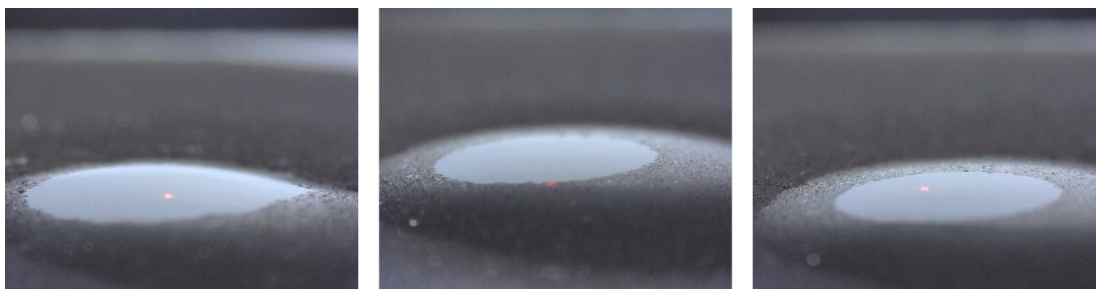
Figura 46 Fotografias representativas do perfil de gotas de 1,2-propeline depositadas sobre a superfície de elétrodo de carbono vítreo modificados com biocarbono (tratado a 1000 °C, sem funcionalização), disperso em DMF e Nafion® 117. As imagens correspondem a três medições independentes utilizadas para a determinação do ângulo de contacto, com o objetivo de avaliar as propriedades de molhabilidade da superfície modificada.
