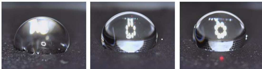
Figura 49 Fotografias representativas do perfil de gotas de etaline depositadas sobre a superfície de eléctrodos de carbono vítreo modificados com biocarbono (tratado a 1000 °C, sem funcionalização), disperso em DMF e Nafion® 117. As imagens correspondem a três medições independentes utilizadas para a determinação do ângulo de contacto, com o objetivo de avaliar as propriedades de molhabilidade da superfície modificada.
