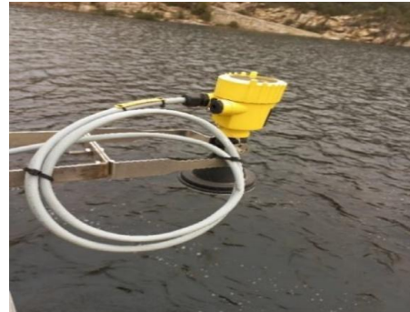
Figura 12 - Medidor automático do nível de água, retirado de (da Costa Mendes, J.M., 2023).
