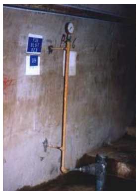
Figura 13 - Manómetro de um piezómetro simples (Moura, G.M.G., 2005)
