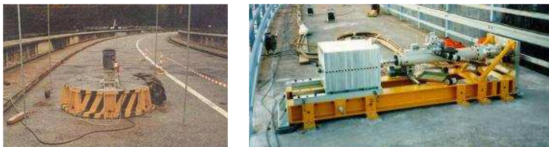
Figura 24 - Vibradores: a) rotativos de massa excêntrica, com motor elétrico (LNEC); b) de translação com motor servo hidráulica (EMPA), retirado de (Mendes, 2010).
