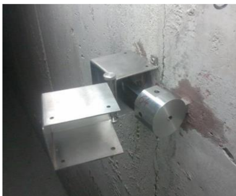
Figura 19 - Base tridimensional, retirado de (Barros, P.S., J., 2016).
