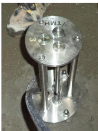
Figura 18 – Cabeça de extensómetro de varas na fundação, retirado de (Sampaio, 2015).
