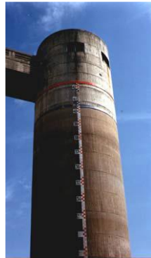
Figura 11 - Escala limnimétrica, retirado de (Moura, G.M.G., 2005).
