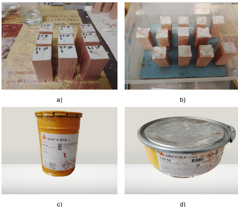
Figura 44 – a) Impermeabilização dos provetes; b) Ensaio de absorção de água por capilaridade; c) Icosit K-101N A; d) Icosit K-101N B.
