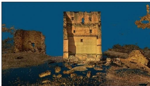
Figura 2 – Caso de estudo da aplicação do scanner a laser na reabilitação [14].
