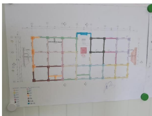
Figura 67-Gestão Visual aplicada à betonagem de vigas de um edifício (Fotografia retirada pela Autora em obra)
