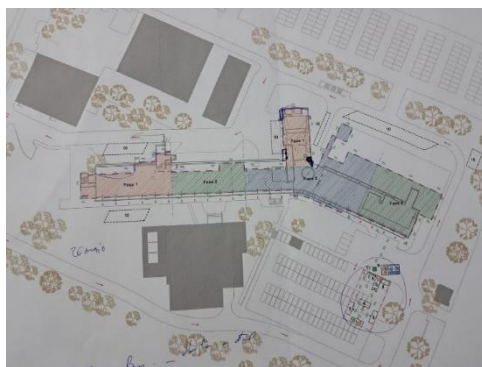
Figura 69-Gestão Visual aplicada ao planeamento de intervenção de obra (Fotografia retirada pela Autora em obra)
