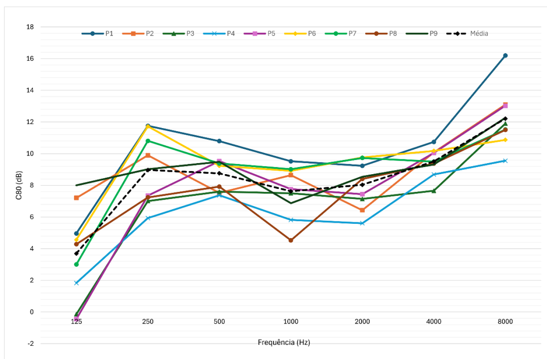
Figura 5.12- Resultados da Claridade ( C_{80} ), com o sistema AVAC ligado, em cada ponto de medição, para bandas de frequência de 1/1 de oitava.
