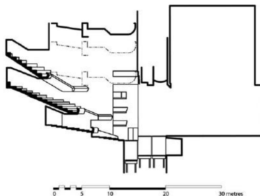
Figura 3.24 – Diferentes posições possíveis do teto móvel do Milton Keynes Theatre, Reino Unido. [23]
