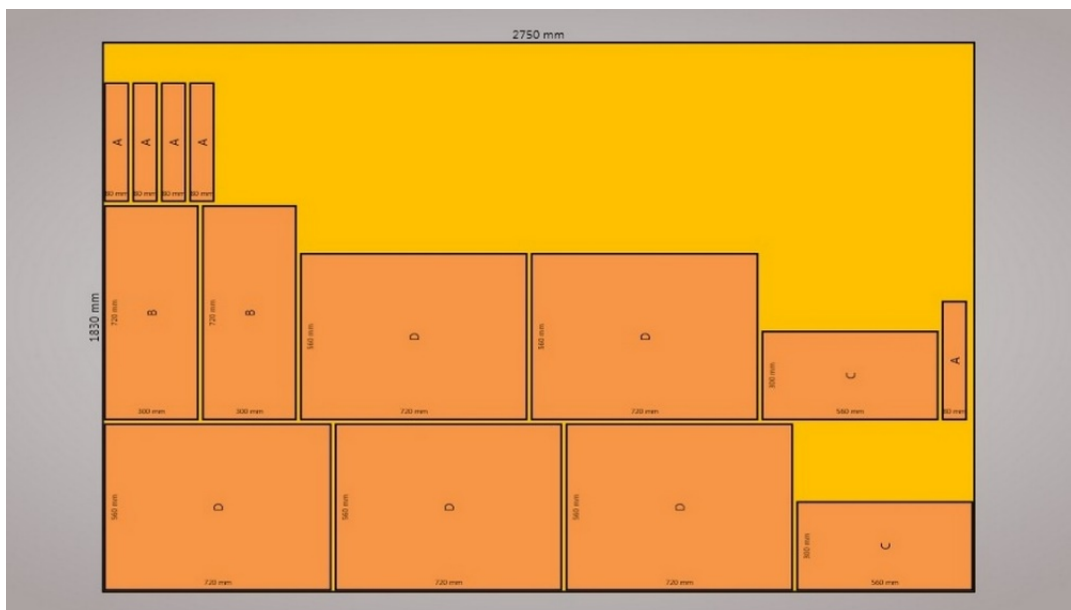
Fig. 1 - Exemplo de lógica subtrativa na marcenaria. Divisão de uma placa de madeira em peças mais pequenas - ferramenta AudioKit [20]
