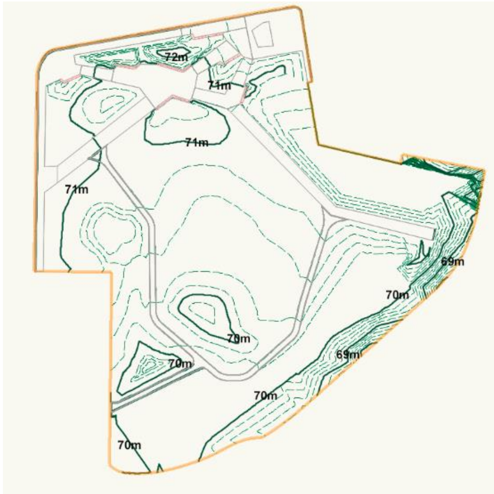
Figura 24 - Vista em planta da modelação final geradas pelo "Vectorworks™" (curvas de nível de 20cm em 20cm)
