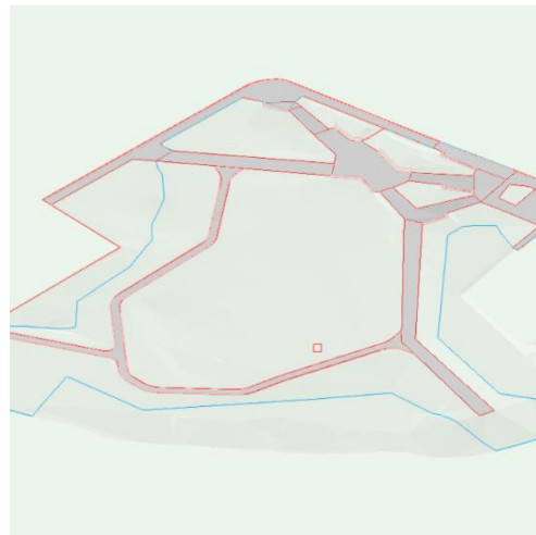
Figura 25 - Ajustes de modelação criados para acomodar os pavimentos (vermelho)
