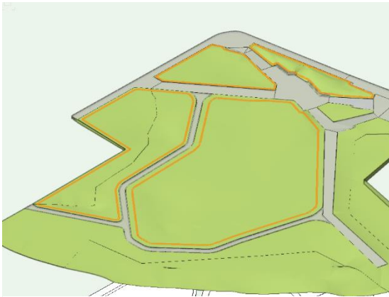
Figura 21 - Seleção de áreas para criação de modelação utilizando curvas de nível (laranja)
