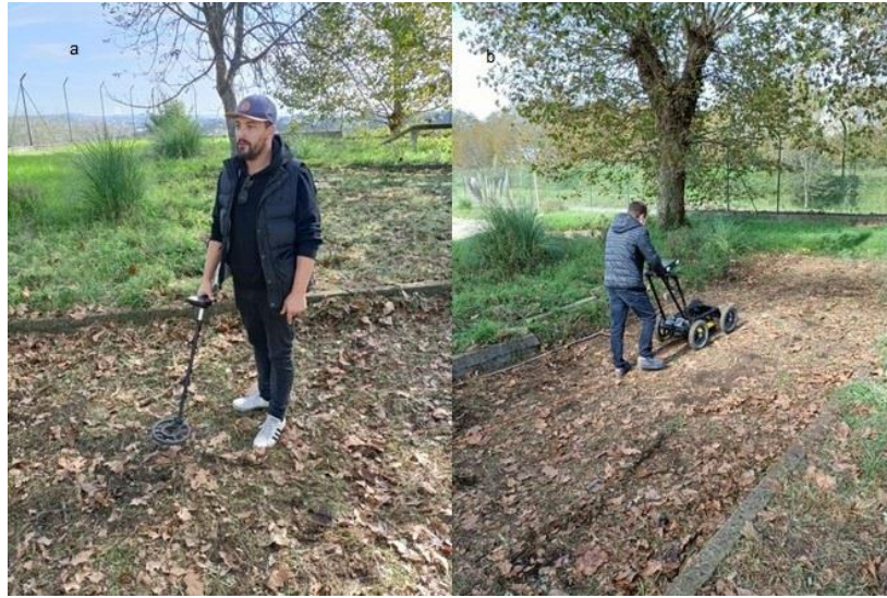
Figura 22 Procedimento da recolha de dados no test site; a) detetor de metais; b) GPR Noggin
