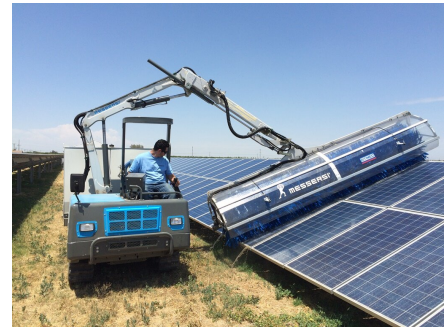
(b) Veículo de limpeza de módulos [19]
