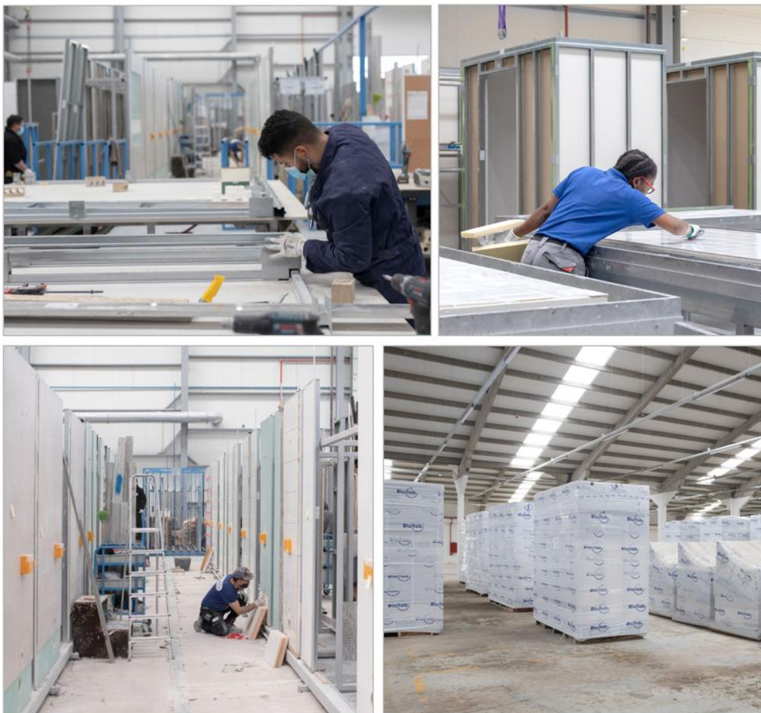
Figura 22 - Diferentes etapas da produção de casas de banho pré-fabricadas em ambiente fabril [51, 61].
