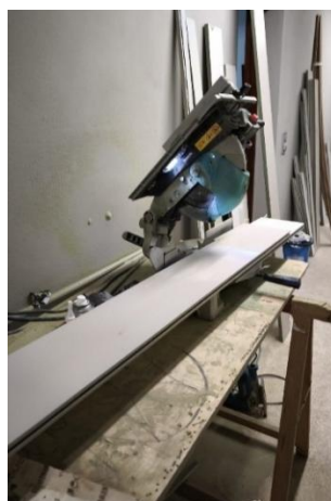
Figura 30 - Serra circular de mesa utilizada para corte de rodapés
