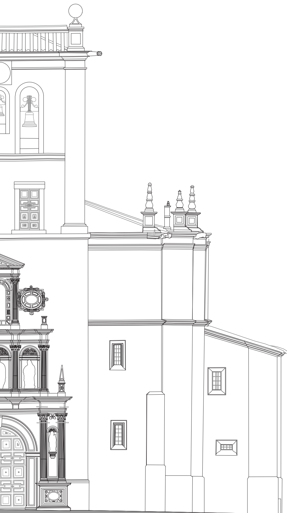
Imagem 01. Alçado Nascente da Igreja de Torre de Moncorvo – Fusão entre imagem raster ortofotográfica à esquerda e o desenho vetorial realizado por decalque a partir da ortofotografia com o auxílio de software de desenho assistido por computador (CAD). (imagem para fins ilustrativos, objeto sem escala)
