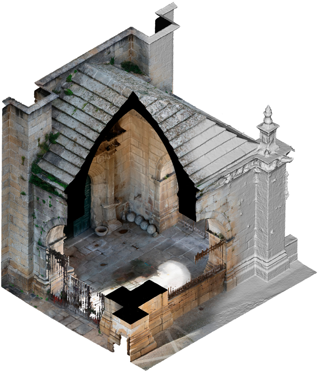
Imagem 65. Modelo do alpendre cortado com e sem textura em vista isométrica.
