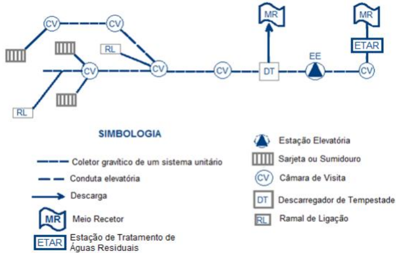
Figura 4: Representação esquemática de um sistema do tipo unitário. Fonte: (Lourenço, 2014)
