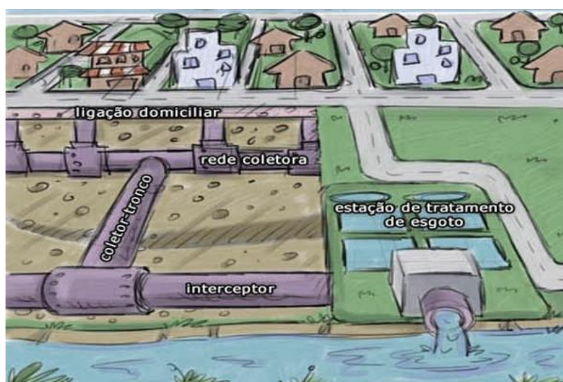
Figura 6: Esquema do sistema da rede coletora. Fonte: (Padrão V. M., 2016).
