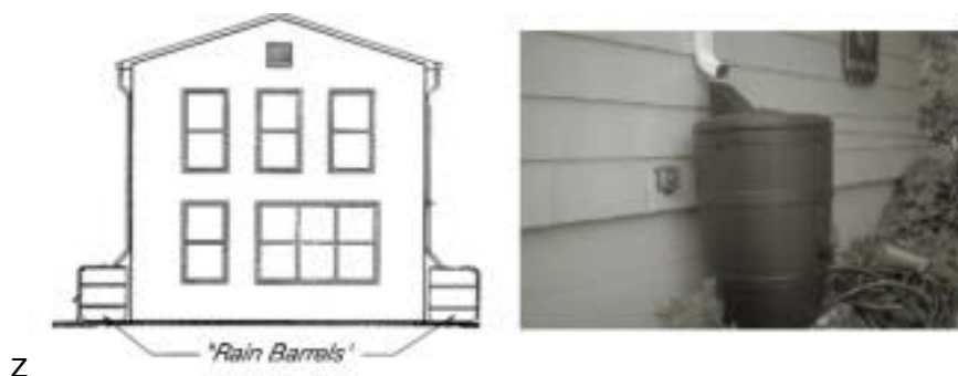
Figura 63: Esquema e imagem explicativa de soluções de origem "Rain Barrels". Fonte: (Gonçalves, 2016).
