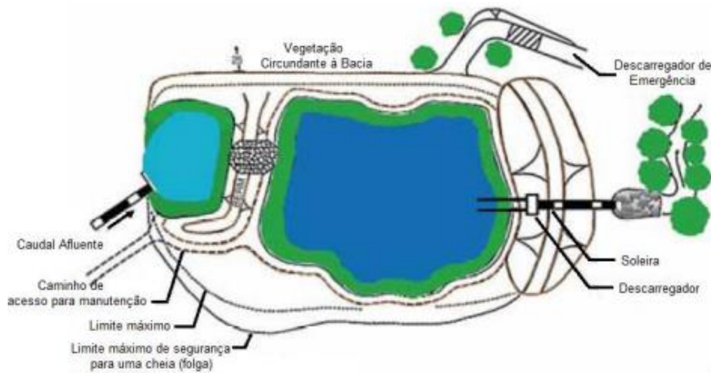
Figura 9: Corte transversal de como uma bacia superficial, de água permanente. Fonte: (Lourenço, 2014)
