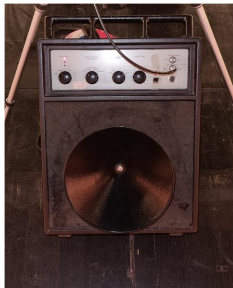
Figuras 4.13 e 4.14 - Fontes sonoras: Fonte sonora Brüel & Kjær ( Echo Speech Source ), modelo 4720 e Fonte sonora Brüel & Kjær, modelo 4224 [Fotos do autor].
