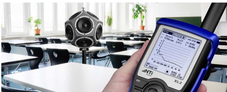
Figura 2.18 - Equipamento de medição do tempo de reverberação [38].
