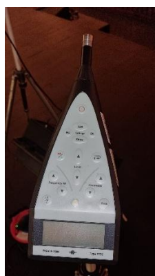
Figura 4.15, 4.16, 4.17 e 4.18 - Equipamento de medição: Sonómetro Brüel & Kjær, 2236, Sonómetro Brüel & Kjær, modelo 2260, Calibrador de microfones Brüel & Kjær, 4231 e Microfone de 13 mm Brüel & Kjær, 4189 [Foto do autor], [79], [80].
