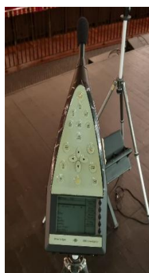
Figura 4.15, 4.16, 4.17 e 4.18 - Equipamento de medição: Sonómetro Brüel & Kjær, 2236, Sonómetro Brüel & Kjær, modelo 2260, Calibrador de microfones Brüel & Kjær, 4231 e Microfone de 13 mm Brüel & Kjær, 4189 [Foto do autor], [79], [80].
