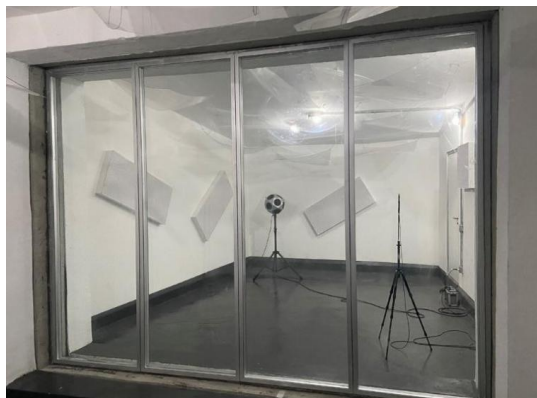
Figura 2.20 - Exemplo de medição da redução sonora em laboratório [46].
