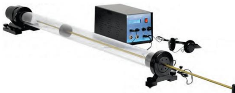
Figura 2.11 - Tubo de ondas estacionárias (tubo de Kundt) [30].
