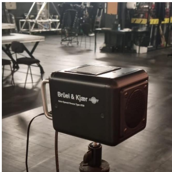
Figuras 4.13 e 4.14 - Fontes sonoras: Fonte sonora Brüel & Kjær ( Echo Speech Source ), modelo 4720 e Fonte sonora Brüel & Kjær, modelo 4224 [Fotos do autor].
