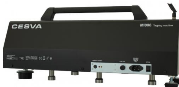
Figura 2.22 - Máquina de percussão para realização de ensaios [49].
