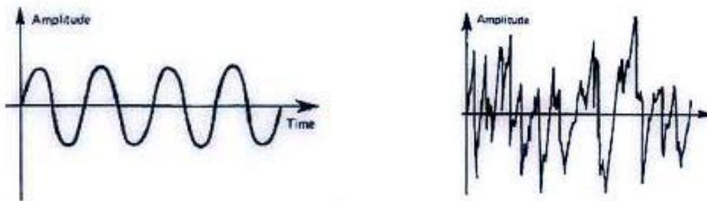
Figura 2.6 - Comparação de oscilogramas dum som puro (esquerda) e um som complexo (direita) [18].
