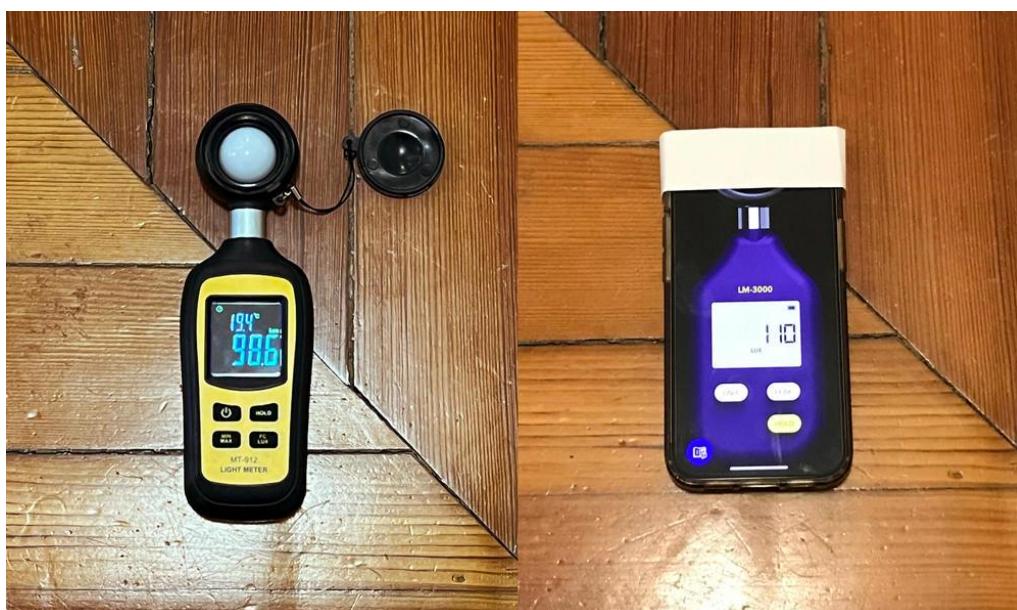
IMG. 51 - medição da iluminância com recurso a equipamento diverso
