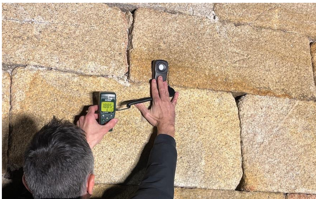
IMG. 61 - medição da iluminância na face frontal da torre de menagem
