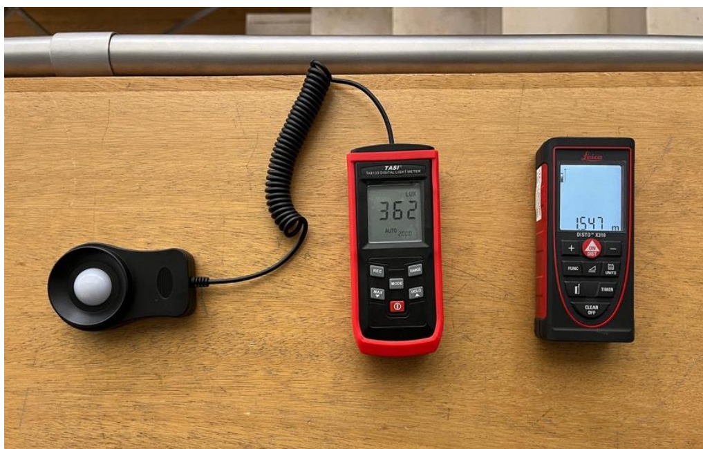
IMG. 120 - medição incorrecta da iluminância no piso superior da biblioteca
