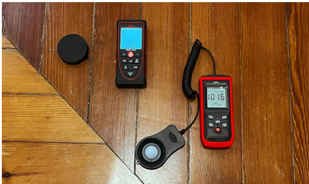
IMG. 50 - medição da distância do piso à luminária e da iluminância
