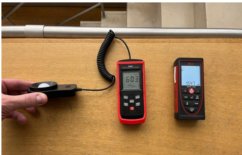
IMG. 119 - medição correcta da iluminância no piso superior da biblioteca
