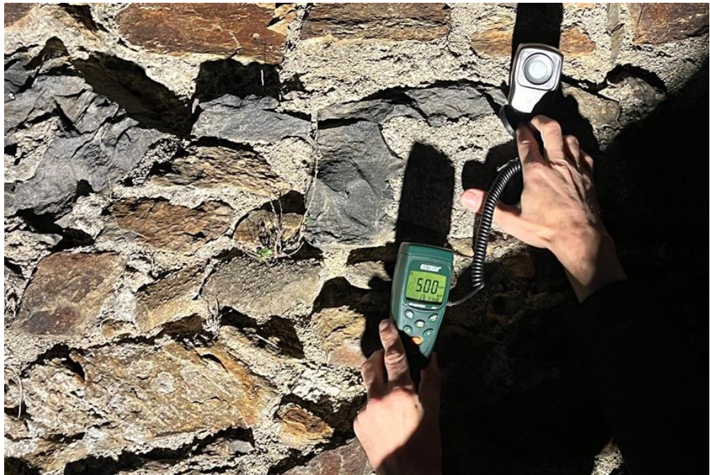
IMG. 98 - medição da iluminância na muralha do castelo, lado Sul, com luxímetro específico para LED
