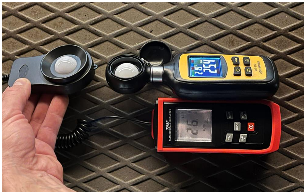
IMG. 55 - medição da iluminância com recurso a dois luxímetros
