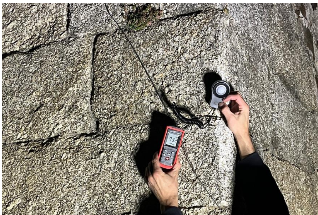
IMG. 101 - medição da iluminância no torreão Poente com recurso a luxímetro universal
