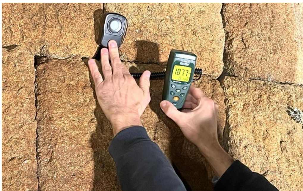
IMG. 62 - medição da iluminância em torno da muralha
