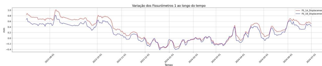
Figura 59 - Variação dos fissurómetros 1 ao longo do tempo
