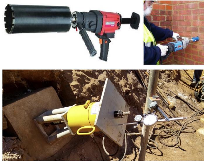
Figura 2.3 - Máquina de extração e ensaio; Ensaio de arrancamento de varões
