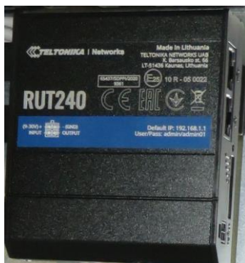
Figura 22 - Router de transmissão de dados
