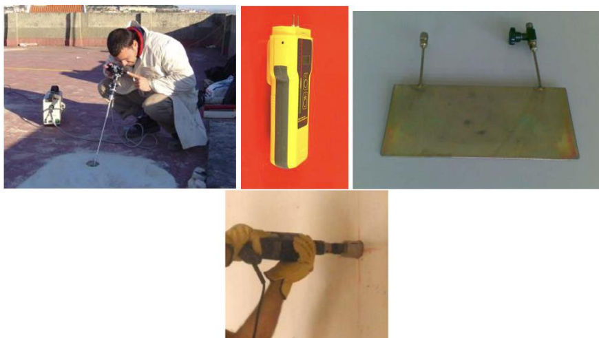
Figura 2.4 - Câmara boroscópica; Humidímetros; Macacos Planos; Ensaio de Arrancamento
