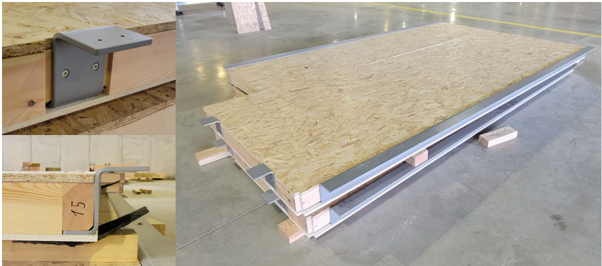
Figura 43 - Vista do perfil de suporte (à esquerda); Vista de dois elementos de teto prontos para serem incorporados no módulo (à direita)
