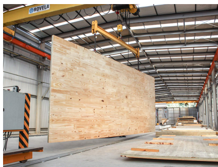
Figura 7- Exemplo de um painel CLT (Kalesnikoff, 2024)
