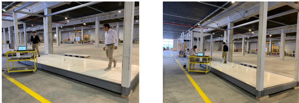
Figura 80 - Vista do módulo durante os ensaios de caminhada sobre a laje
