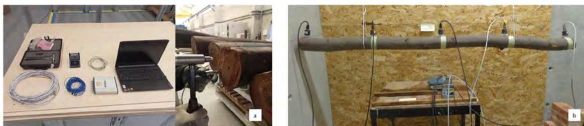
Figura 2. Ensayos de medición de Ondas acústicas longitudinal-Oal (a) y de Vibración transversal-Vt (b).
