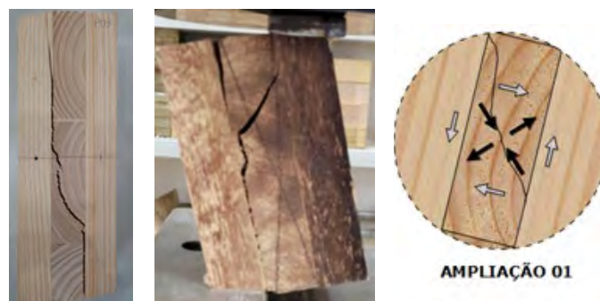
Figura 2. Formas de ruptura encontradas nos corpos de prova durante os ensaios
