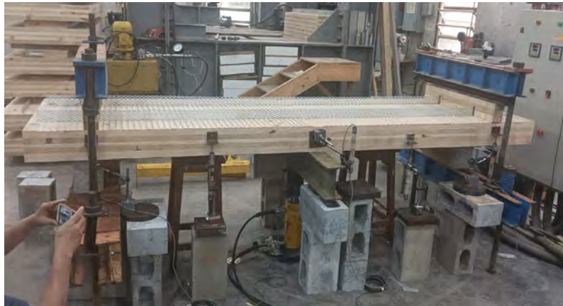
Figura 2. Configuração do ensaio de flexão a três pontos
