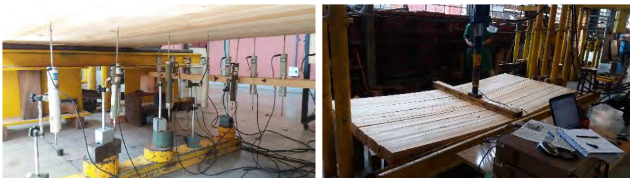
Figura 1: Ensaio e instrumentação dos painéis de DLT e NLT.
