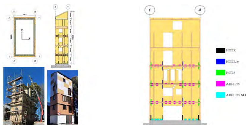
Figura 1. Vistas de la estructura durante la construcción (izquierda), en su estado terminado (centro) y de la configuración típica de uniones
