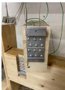
Figura 2. Posición de los termopares en la conexión, uno en la zona de madera-madera y otro sobre la placa metálica
