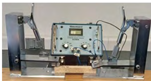
Figura 1. Pruebas de ondas de esfuerzo en el material compuesto
