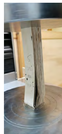
Figura 3. a) Resistencia a compresión frente al contenido de humedad del adhesivo en la capa de fallo. b) ejemplo de fallo a compresión
