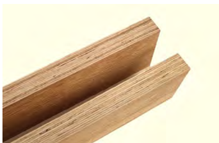
Figura 1. Microlaminado de Eucalyptus globulus en configuraciones L (abajo) con todas las chapas orientadas en dirección longitudinal y T (arriba) con la tercera chapa desde la parte superior e inferior orientada en dirección transversal.
