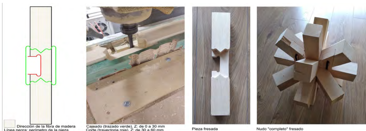
Figura 3. Trayectorias de corte, proceso de fresado y producto final de una pieza y nudo “completo” del sistema “Spatial Masterkey”
