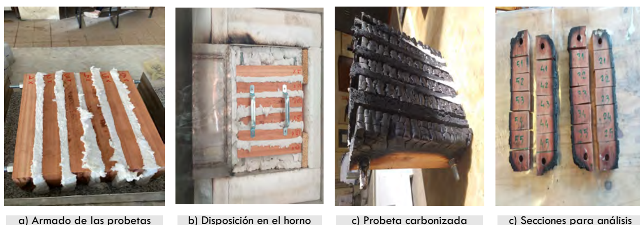
Figura 1. Configuración de las probetas de ensayo y de evaluación de resultados
