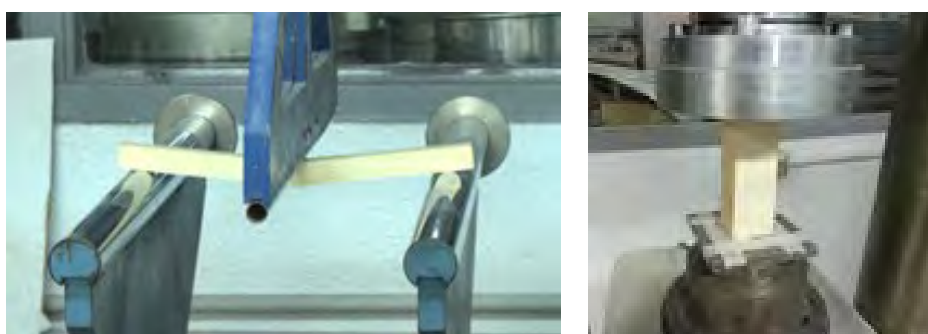
Figura 4. Ensayos destructivos. De izquierda a derecha: flexión y compresión paralela
