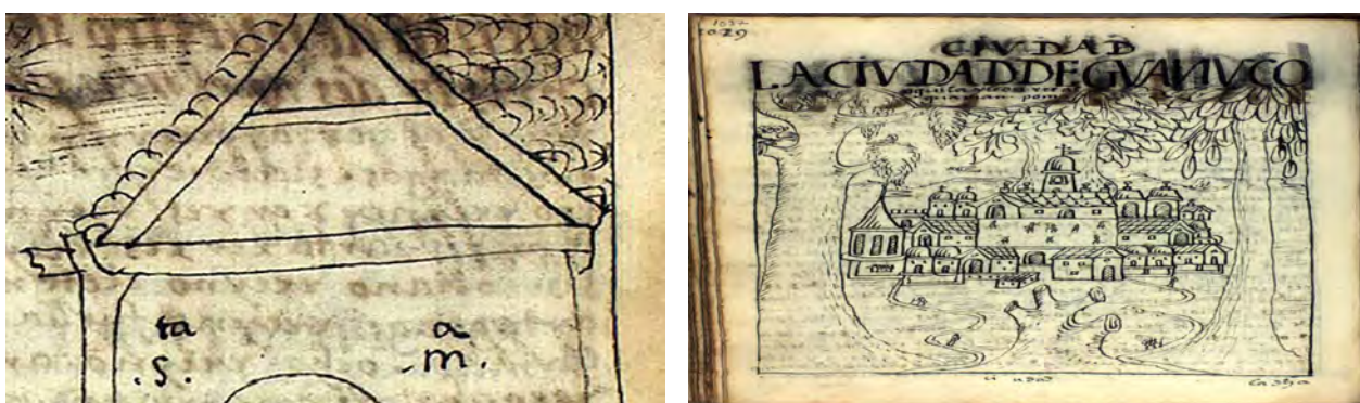
Figuras 4 y 5. Armadura de par y nudillo con rollizos, gran pendiente y perfil de sobrepares (Guamán Poma, 1615, f.30, f.1037).
