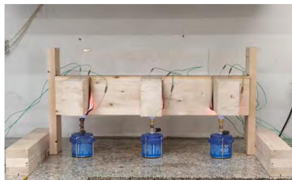
Figura 3. Montaje para el ensayo de las conexiones frente a la temperatura
