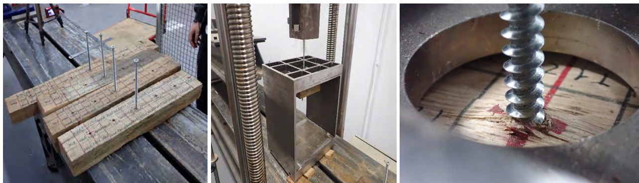
Figura 1. Probetas marcadas (izquierda), dispositivo de aplicación de carga (centro) y tornillo tras el arranque (derecha).
