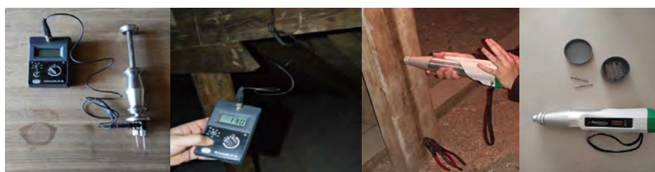
Figura 1. Mediciones con el xilohigrómetro, izquierda. Ensayo con el penetrómetro, derecha. Fuente: Elaboración propia.
