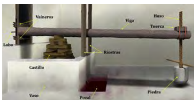
Figura 2. Elementos de una prensa
