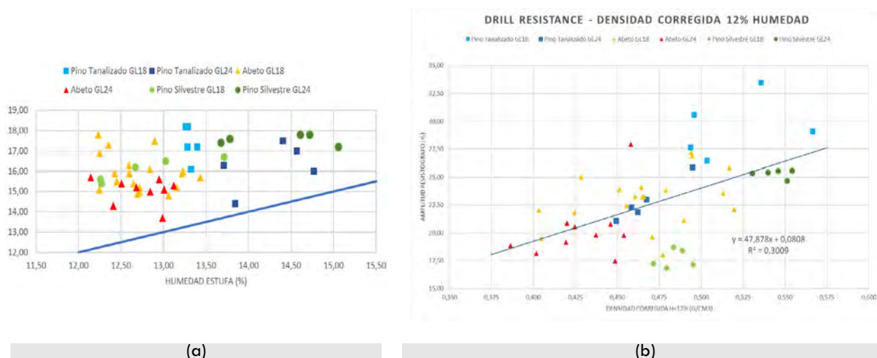
Figura 2. (a) Humedad en estufa vs. Humedad medida con xilohigrómetro; (b) Densidad corregida al 12% de humedad vs. Amplitud resistográfica.
