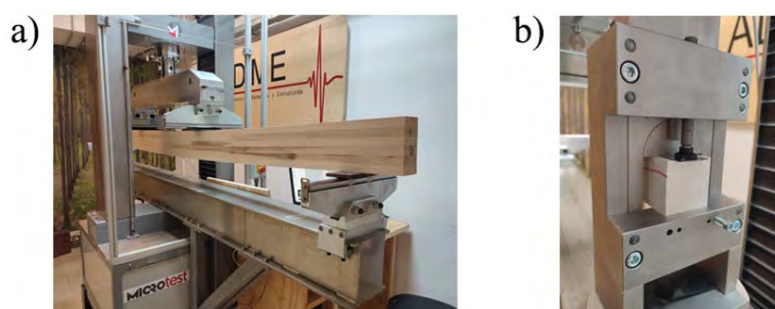
Figura 2. Ensayos realizados a las vigas laminadas. a) Flexión. b) Cortante por línea de cola.
