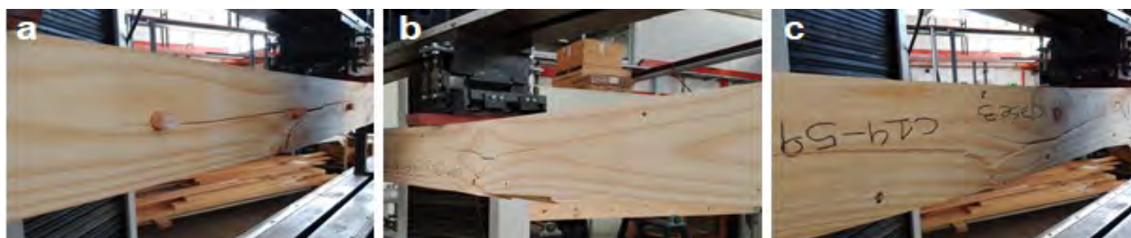
Figura 3. Patrón de falla en paneles de tamaño estructural en flexión. a. Panel DLT. b. Panel WNLT. c. Panel NLT
