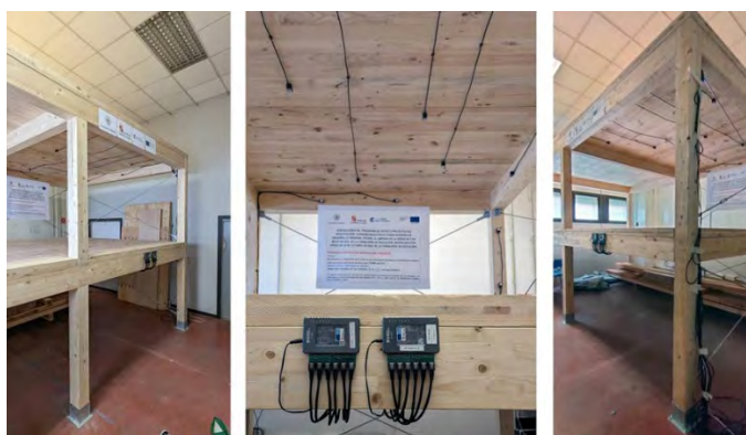
Figura 1. Estructura de madera (MLE+CLT) experimental desarrollada y sensorizada.
