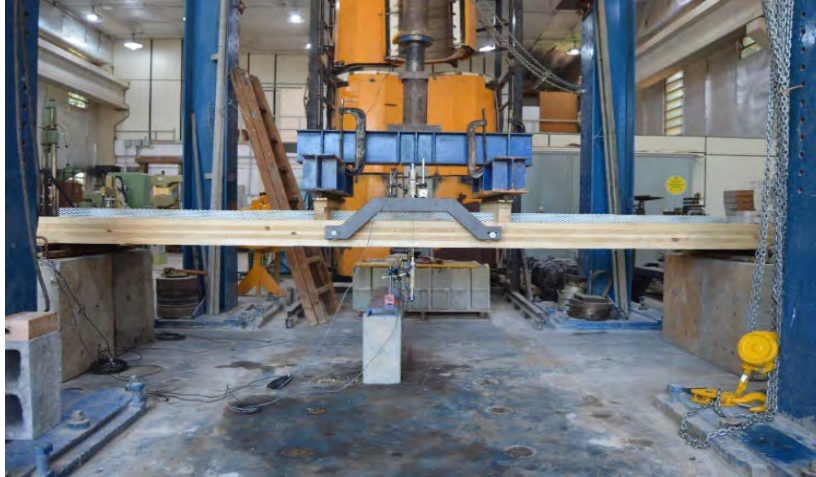
Figura 1. Configuração do ensaio de flexão a quatro pontos
