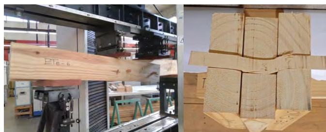
Figura 4. Configuración de ensayo y modo de fallo en ensayos de flexión de uniones.
