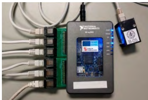
Figura 3. MyRIO con dos placas adaptadoras y un acelerómetro.
