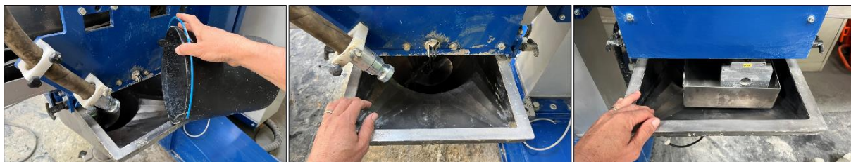
Figura 3 - a) Inserção de material no funil com o uso de baldes; b) Pequena abertura livre para inserção de material; c) Lado oposto do funil de difícil acesso. Fonte: Autores.
