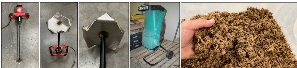
Figura 10 - a) Misturador elétrico manual com haste adaptada; bc) Detalhe da haste de aço inoxidável para dispersão de fibras de papel; d) Triturador de jardinagem; e) Fibras dispersas provenientes da reciclagem das embalagens de sacos de cimento. Fonte: Autores.
