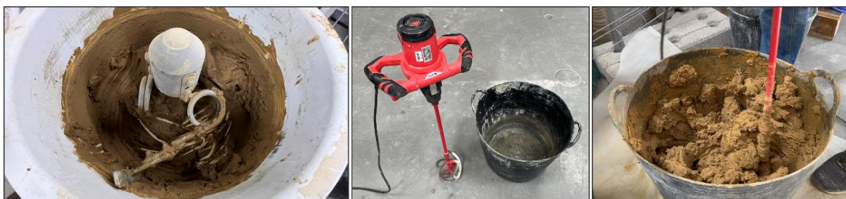
Figura 6 - a) Misturador de argamassa de cimento com a mistura base de terra; b) Misturador elétrico manual Rubimix 9N e balde; c) Misturador elétrico manual a trabalhar. Fonte: Autores.
