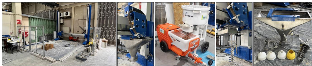
Figura 2 - a) Impressora Smart 2500 da BE MORE 3D; b) Sistema aberto de inserção de material; c) Bomba injetora; d) Rosca sem fim; e) Bicos extrusores. Fonte: Autores.
