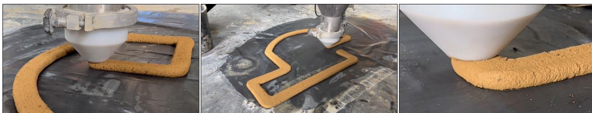
Figura 8 - Impressão com acabamento liso. Foi utilizada RVEFE que produziu cordões de extrusão com mesma largura que o diâmetro de saída do bico extrusor. Fonte: Autores.
