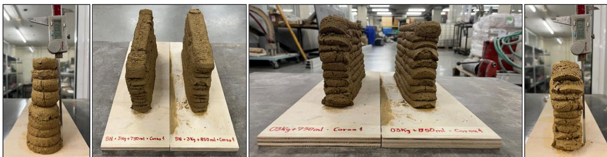
Figura 5 - Na esquerda, medição do abatimento com amostra base. Na direita, medição do abatimento com maior quantidade de água na mistura. Fonte: Autores.
