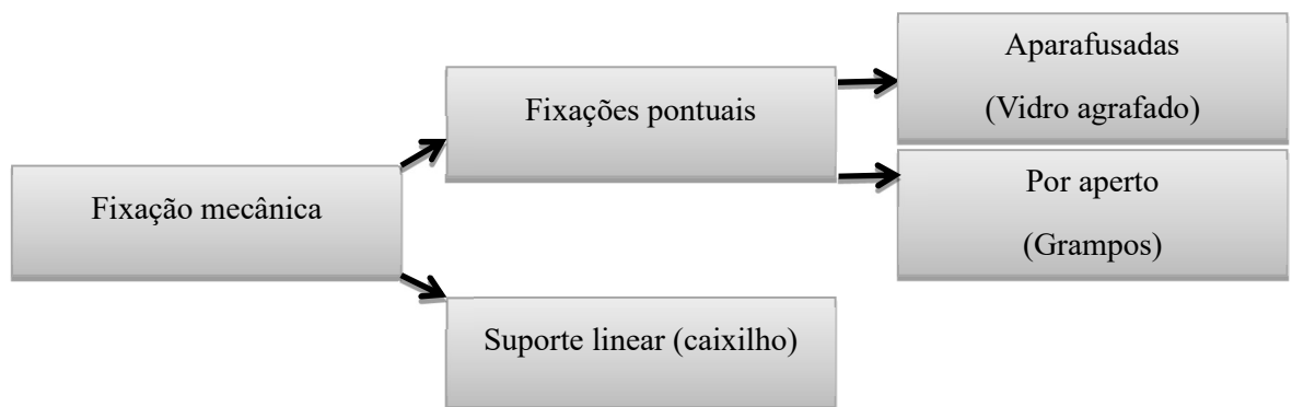
Figura 22. - Fixações mecânicas mais frequentemente usadas [15]
