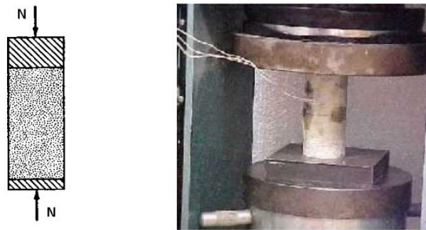
Figura 15 Ensaio de compressão uniaxial (Lima , et al., 2024)
