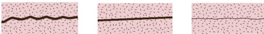
Figura 21 Diferentes tipos de falhas, nível de rugosidades e aberturas (Lima , et al., 2024)
