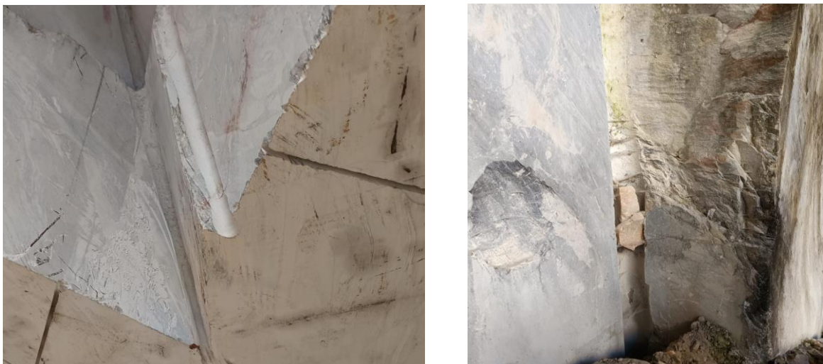
Figura 10 Exemplo de canais de furação para delimitação do corte
