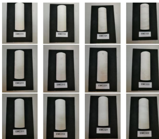
Figura 31 Proveteis sujeitos ao ensaio de determinação da resistência à compressão (Técnico, 2019)
