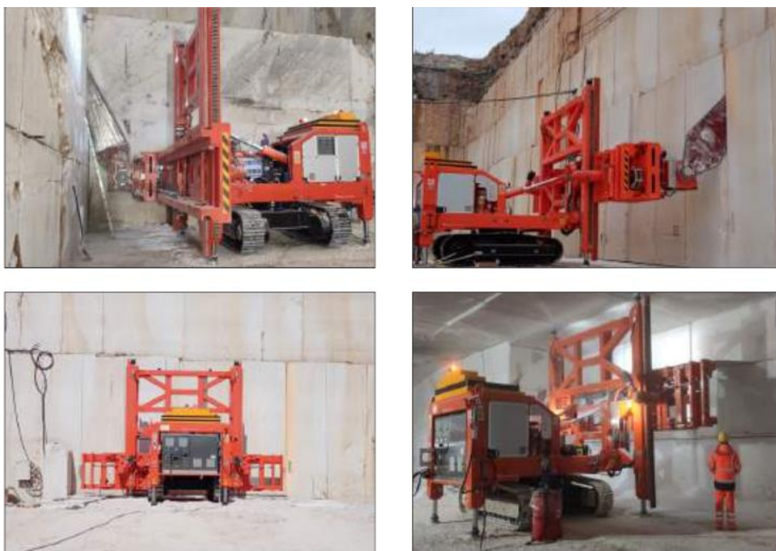
Figura 9 Máquina de fio diamantado GU70 (Fantini)
