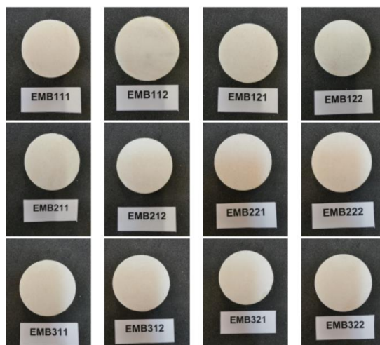
Figura 30 Provetes utilizados para o ensaio de determinação da resistência à tração (Técnico, 2019)
