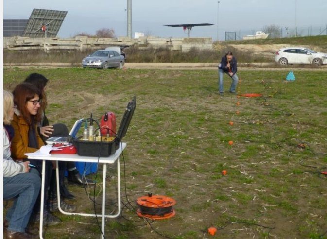
Figura 3 - Ensaios geofísicos pelo método das ondas superficiais
