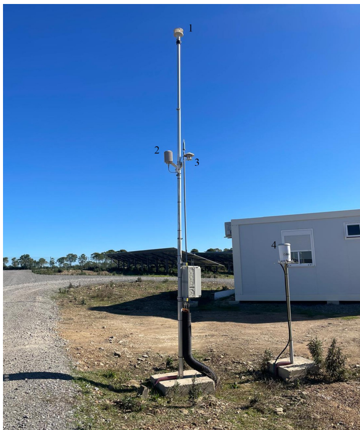
Figura 3.11: Estação meterológica montada numa central fotovoltaica.
