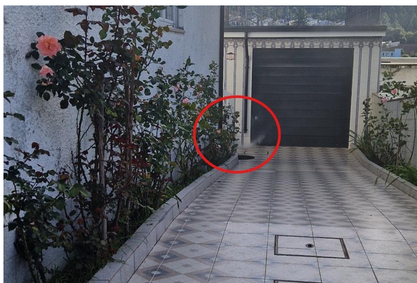
Figura 33 - Afluência indevida identificada na Rua dos Girassóis, com recurso ao teste de fumos.
