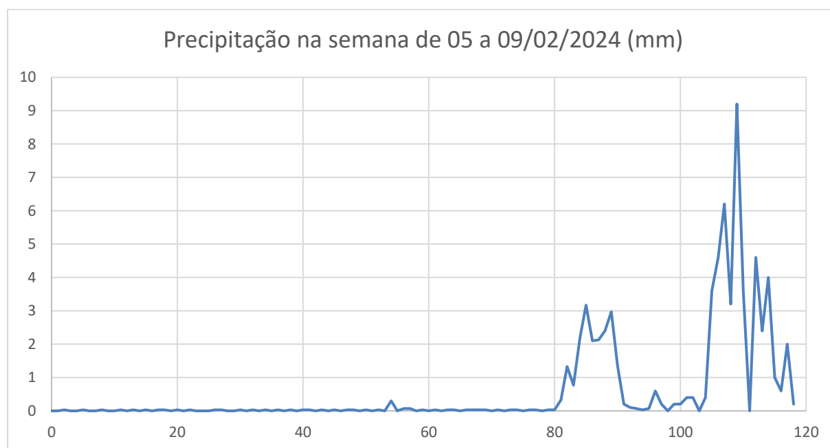
Figura 34 - Gráfico da precipitação (em mm, no eixo dos yy) em função do tempo, ao longo da semana de 5 a 9 de fevereiro de 2024 (em horas, no eixo dos xx).
