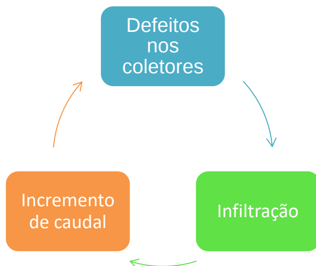
Figura 6 - Ciclo provocado pelas deficiências nos coletores (adaptado de Bonito, 2014).
