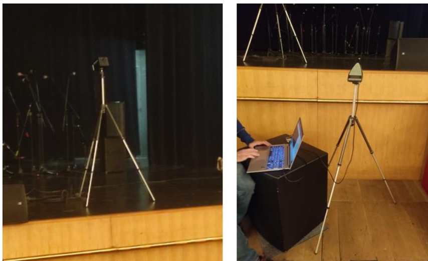
Figuras 5.5 e 5.6 - Fonte sonora instalada no centro do palco (esq.), e o software DIRAC (dir.), no Teatro Ribeiro Conceição [fotos da autora].
