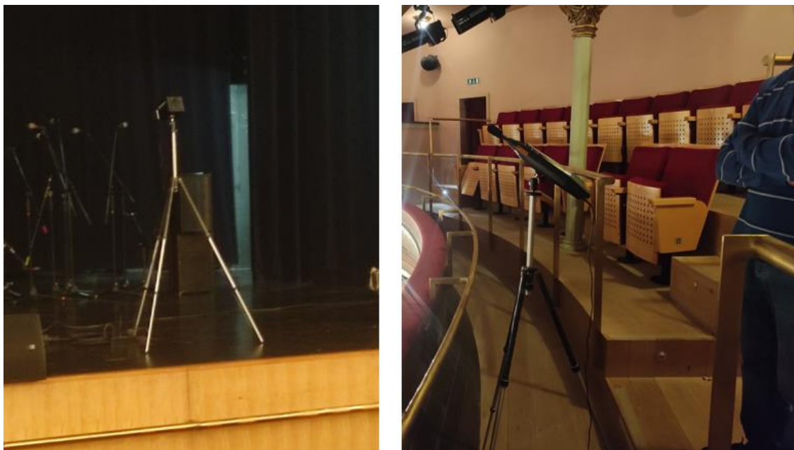
Figura 5.2 e 5.3- Fonte sonora (esq.) Sonómetro aplicado no tripé no Teatro Ribeiro Conceição [fotos da autora].
