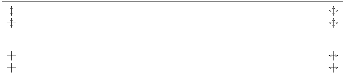
Fig. 3.10 – Representação esquemática dos apoios do tabuleiro de uma ponte com 2 planos de painéis por viga longitudinal
