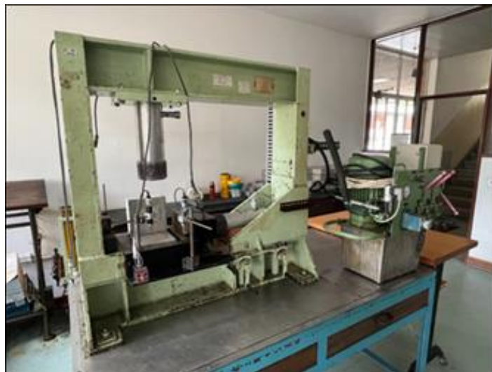
Fig. 15 - Equipamento do ensaio de deslizamento do LNEC.
