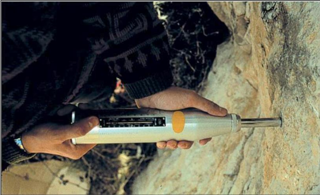
Fig. 7 - Ensaio do martelo de Schmidt (Fonte: https://edisciplinas.usp.br ; Acesso em 12/09/2023 às 16:30).
