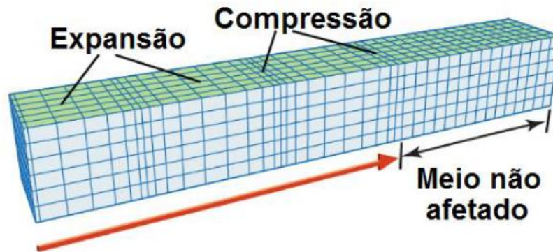
Figura 19 – Deslocamento das partículas causado pela propagação das ondas P (Pinto, 2016)
