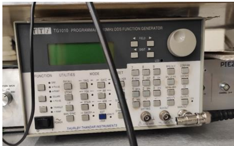
Figura 41 - Gerador de funções TTI TG 1010®
