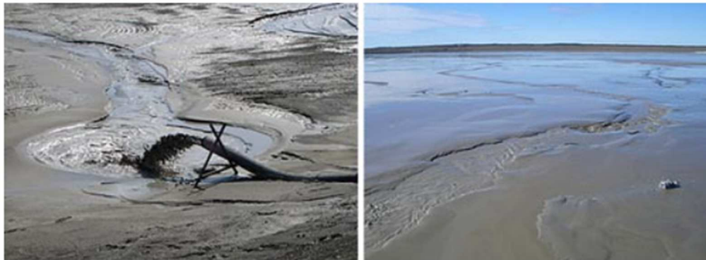
Fig. 3 – Deposição subaérea (à esquerda) e corrente de baixa velocidade contendo rejeitados (à direita), adaptado de Engels (2006).
