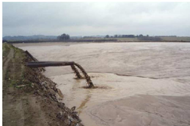
Fig. 6 – Descarga de ponto único (adaptado de https://www.tailings.info/basics/tailings.htm ).
