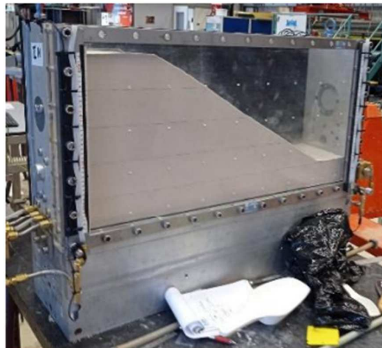
Fig. 44 – Fotografia do modelo físico instalado na centrífugadora, adaptado de Rios et al. (2024).
