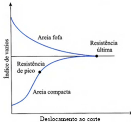
Fig. 28 – Natureza da variação do índice de vazios em relação ao deslocamento de corte, adaptado de Das (2011)
