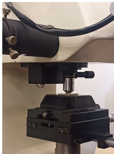
Figura 13. Pesquisa das diagonais através da ampliação 400x.
