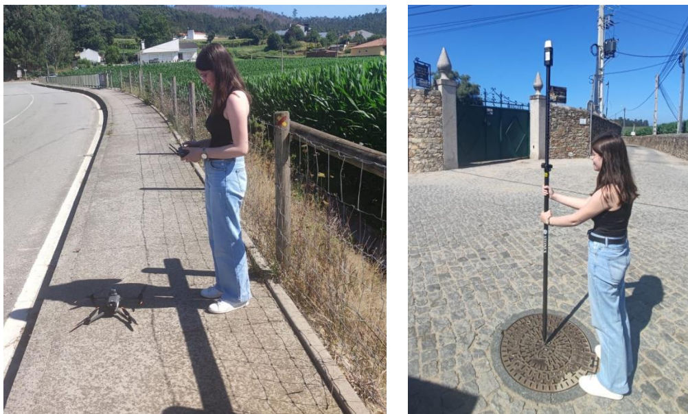
Fig. 11 – Fotografias do levantamento com drone e do levantamento dos pontos efetuados em Arcos.
