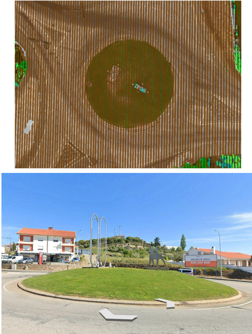
Fig. 51 – Exemplo de um erro encontrado na classificação da nuvem de pontos de Macedo de Cavaleiros, em que pontos, neste caso, de estátuas foram classificados como solo (castanho) e vegetação (azul turquesa).
