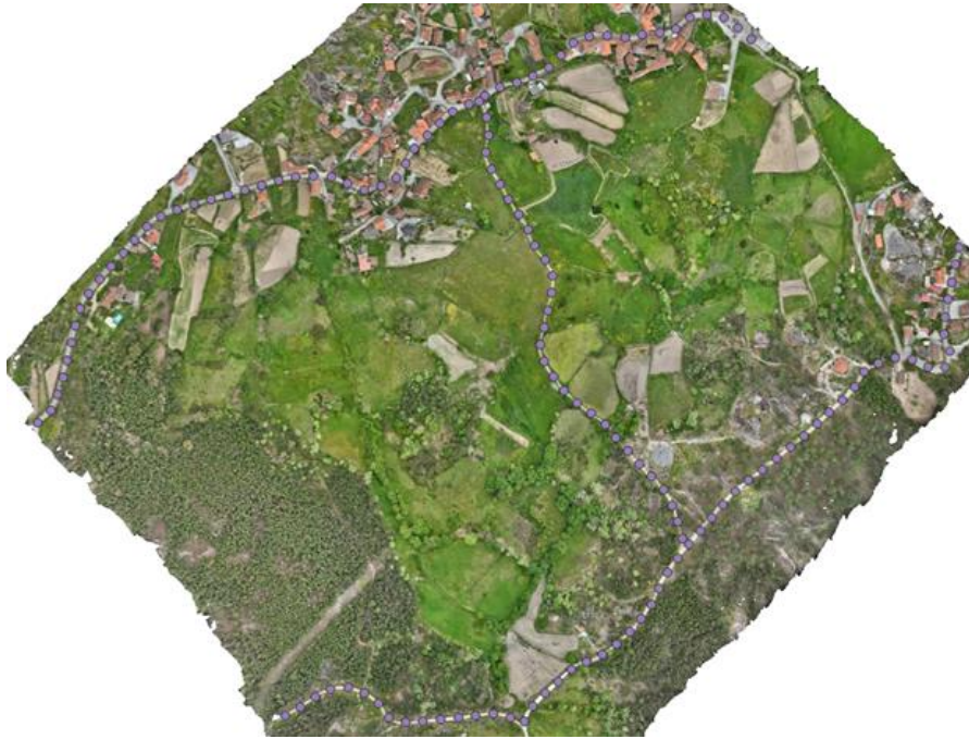
Fig. 8 – Pontos criados ao longo das linhas com o plugin QChainage . A distância entre pontos é de 20 metros.
