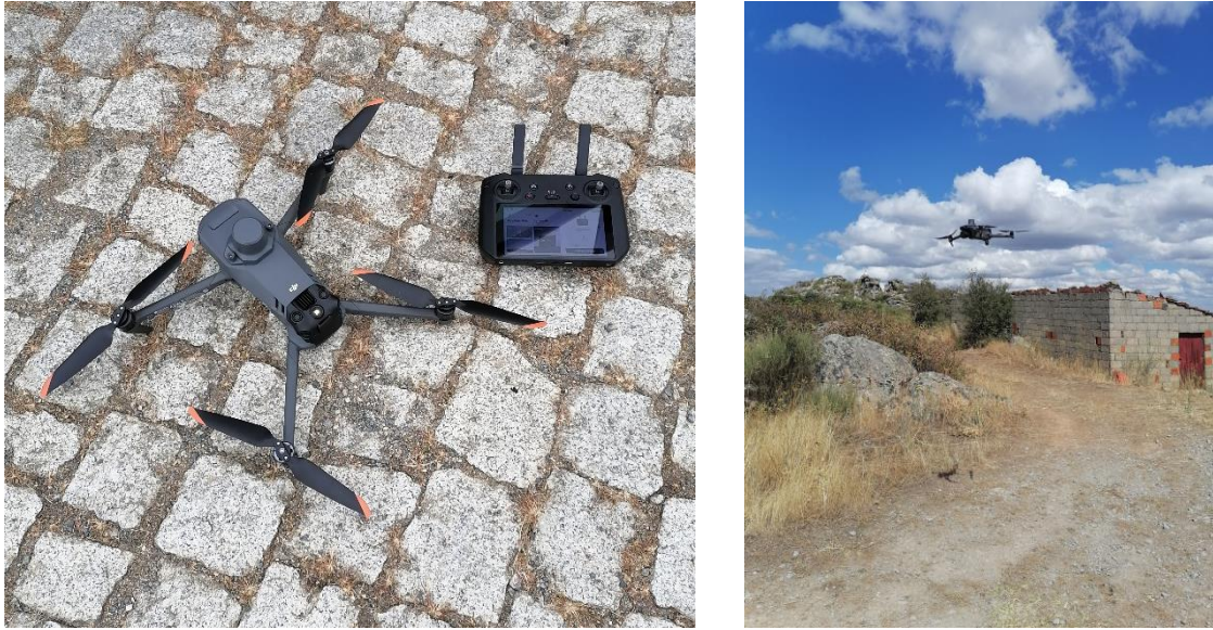
Fig. 2 – Drone DJI Mavic 3 Enterprise utilizado no levantamento aéreo, juntamente com o controlador.
