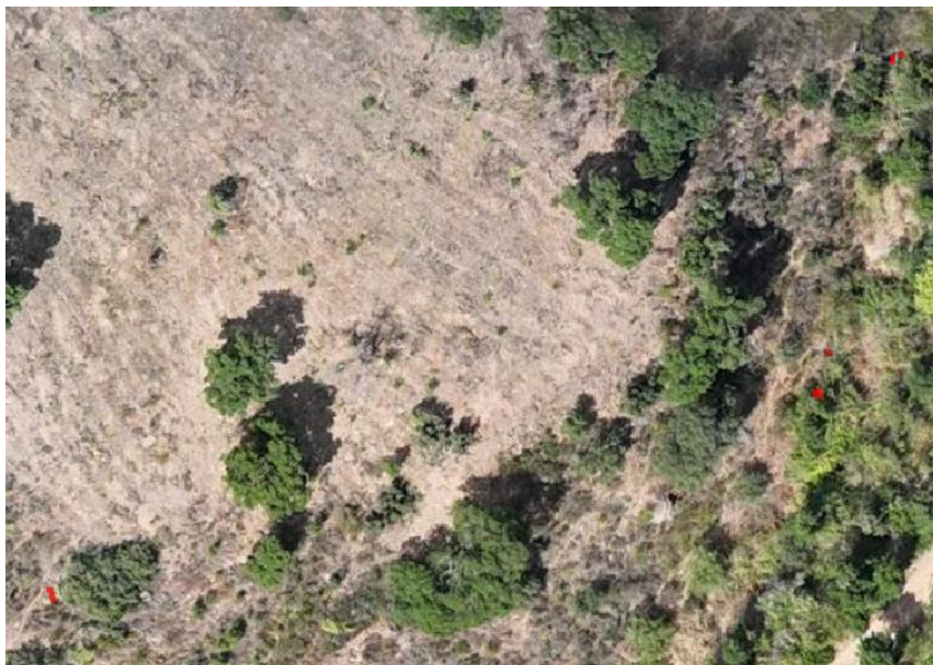
Fig. 48 – Exemplo de outro erro encontrado na classificação da nuvem de pontos de Algosó, em que pontos de solo e vegetação foram classificados como ruído.
