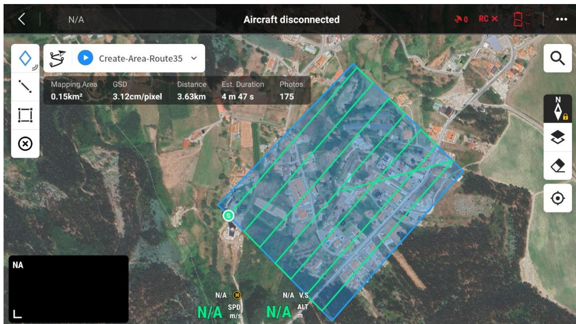
Fig. 21 – Planeamento do voo efetuado em Valpedre na aplicação DJI Pilot 2.
