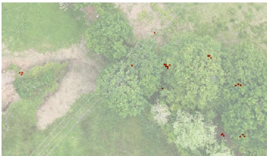
Fig. 42 – Exemplo de mais um erro encontrado na classificação da nuvem de pontos do ICNF, em que pontos de solo e vegetação foram classificados como ruído.
