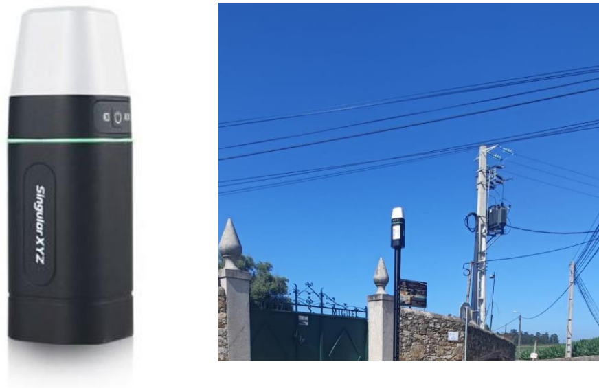
Fig. 3 – Recetor SingularXYZ Sfaira One utilizado em todos os levantamentos de pontos do trabalho (fonte da imagem da esquerda: www.singularxyz.com ).
