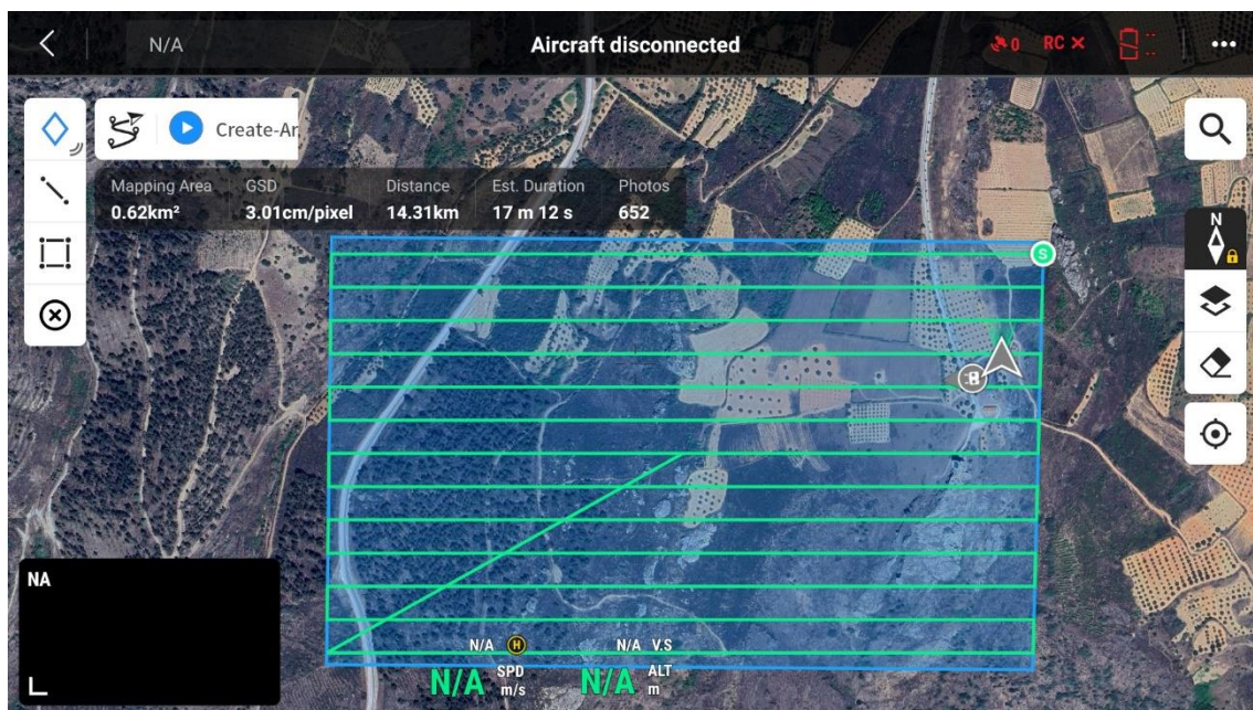
Fig. 28 – Planeamento do voo efetuado em Algosó na aplicação DJI Pilot 2.
