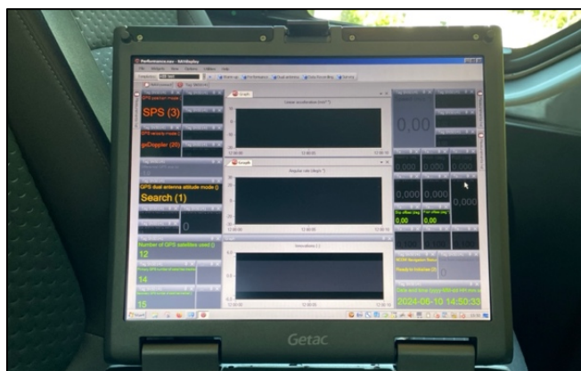
Figura 9 - Visualização da performance do sistema GNSS/INS através do NAVdisplay.
