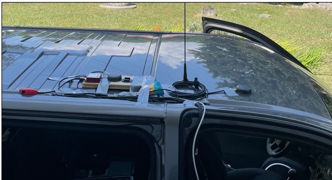
Figura 8 - Montagem do sistema GNSS/INS no automovel.
