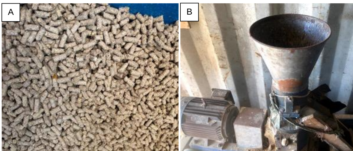
Fig.29 - A: Ração em pellets, pronto para ser distribuído aos camarões. B: Máquina granuladora. (fotos do autor)
