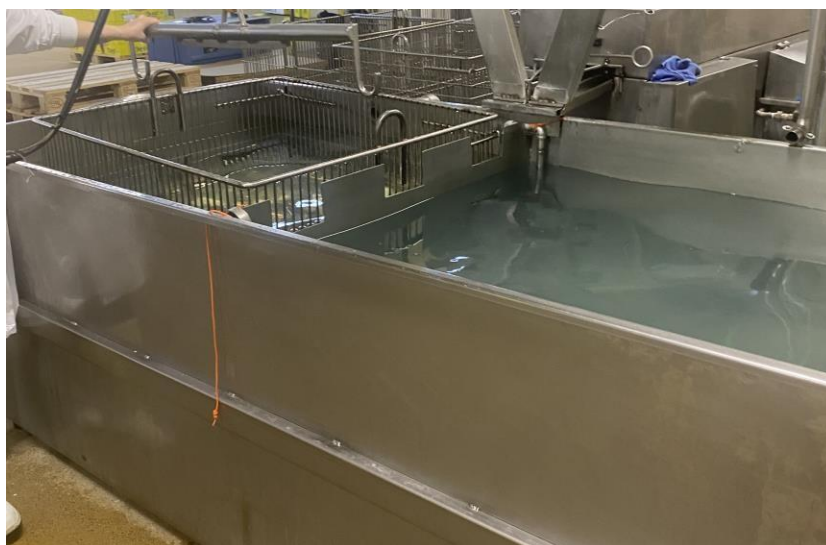
Figura 20 Etapa final da lavagem: Receção das latas num tanque com água -
