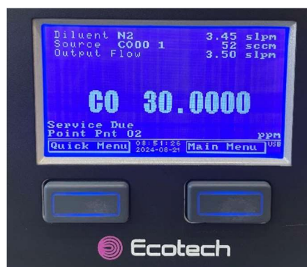
Figura 15 – Visor do diluidor dinâmico enquanto gera a concentração de 30 ppm de CO. Caudal mássico do gás zero: 3,45 slpm; caudal mássico do gás de span: 52 sccm; caudal de saída: 3,50 slpm
