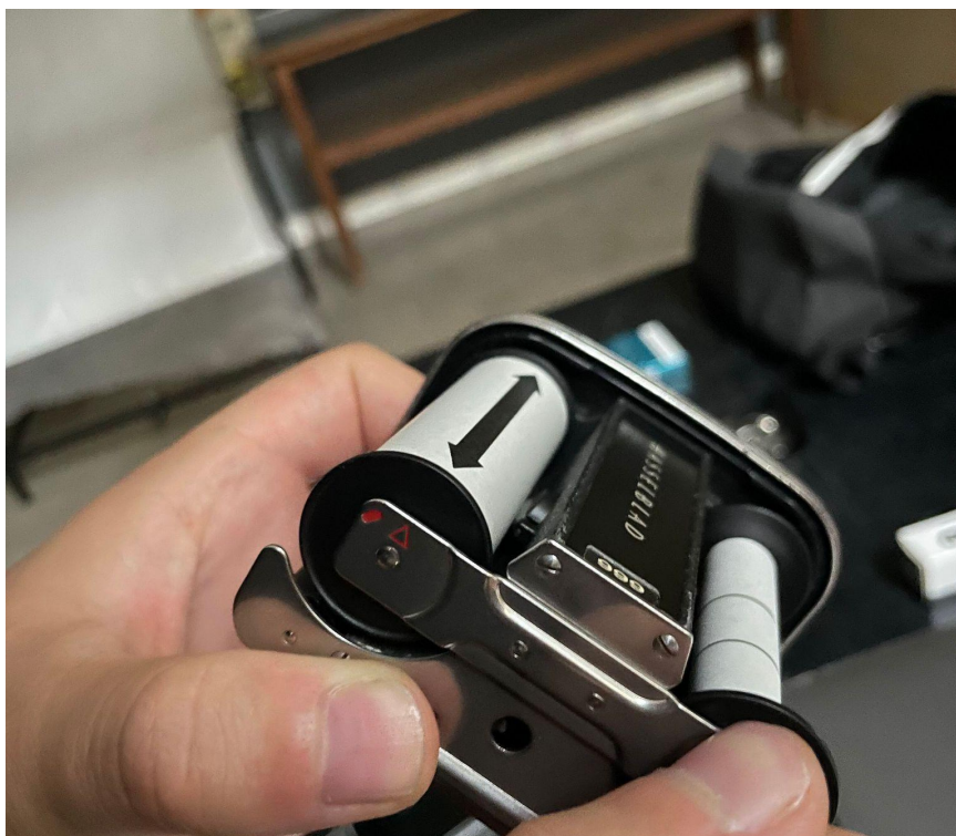
Fig.4 - Processo de introdução do filme na câmara fotográfica
