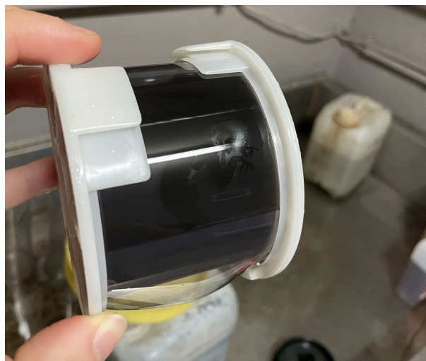
Fig.31 - Filme já removido do tanque e já revelado
