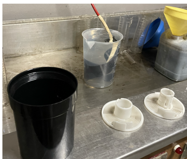
Fig.32 - Lavagem final do filme com água corrente
