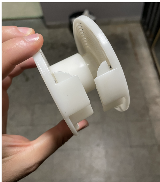
Fig.27 - Bobine adaptada para médio-formato
