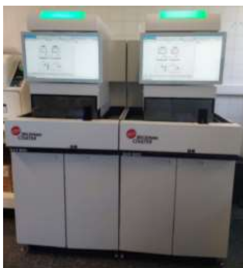
Figura 4 - Analisador de parâmetros hematológicos através da tecnologia VCSn e Princípio de Coulter - DxH 900, Beckman Coulter. Cedido por ULSO – Hospital de Torres Vedras
