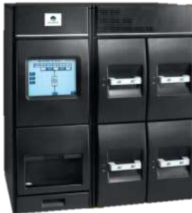
Figura 22 - Equipamento BACT/ALERT 3D, bioMérieux, automatizado para a detecção de microrganismos em frascos de hemocultura. Adaptado de bioMérieux , 2020 (82)
