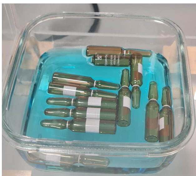
Figura 19 - Ampolas mergulhadas em corante azul de metileno 0,1% sujeitas ao teste de estanquidade.
