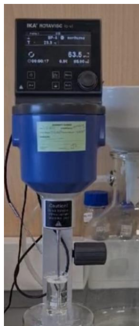
Figura 15 - Medição da viscosidade com um viscosímetro rotativo IKA ROTAVISC LO-VI.
