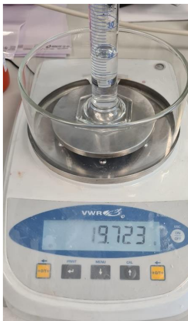
Figura 14 - Exemplo de medição do valor da massa volúmica de um produto líquido.
