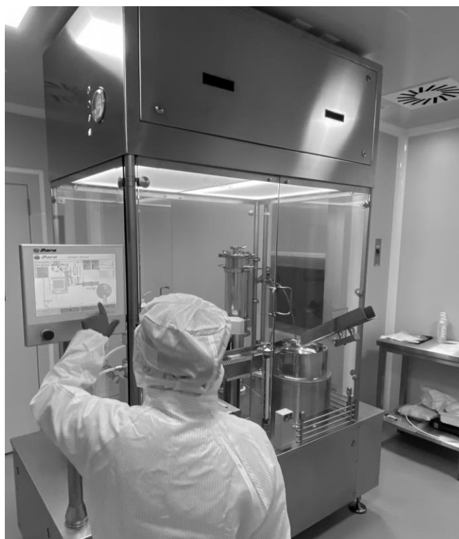
Figura 6 - Sala classificada com máquina de enchimento de seringas pré-carregadas de ácido hialurónico crosslinked (DM classe III) com fluxo laminar incorporado.
