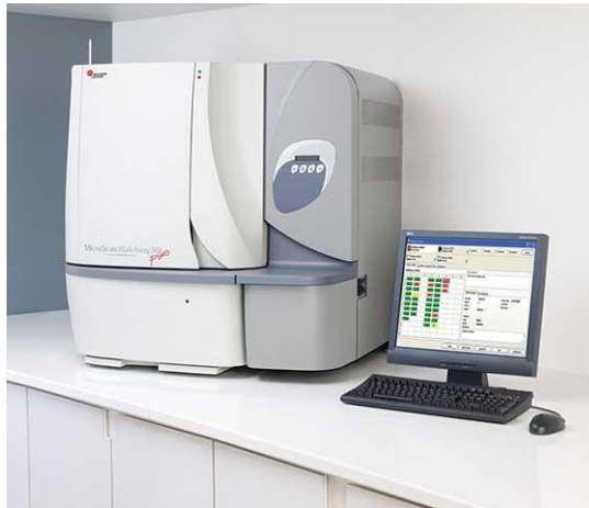
Figura 12. Sistema MicroScan WalkAway 96 plus da Beckman Coulter para a realização de antibiogramas (42).
