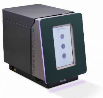
Figura 9. Instrumento CUBE 30 touch da Diesse para a determinação da velocidade de sedimentação (32).
