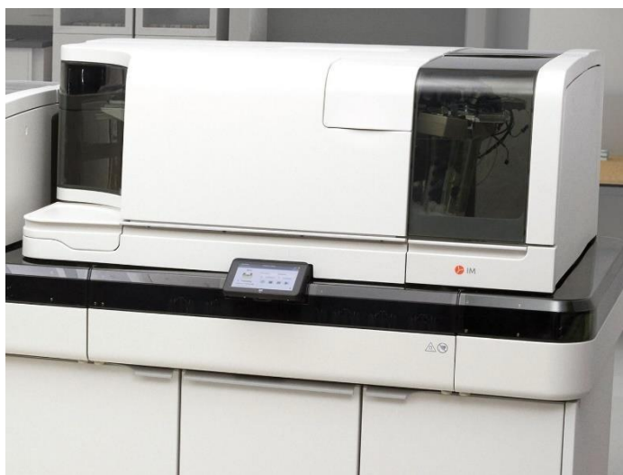
Figura 4. Autoanalizador de imunoensaios por quimiluminescência Atellica® IM 1600 Analyzer da Siemens Healthineers (11).
